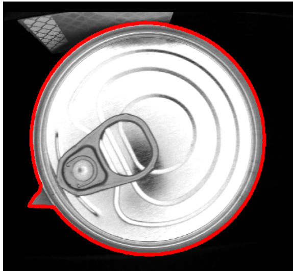
Figura 3.10: Imagem de uma lata captada pela segunda câmara onde é avaliada a circularidade da região representada a vermelho.
