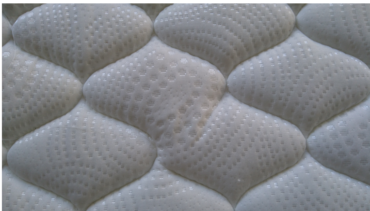
Figura 3.29: Exemplo uma amostra de colchão analisada, onde se observa um defeito na costura.
