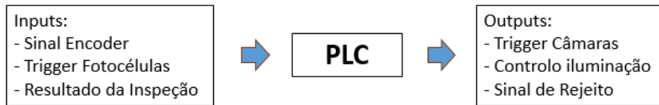
Figura 3.6: Esquema geral das entradas e saídas do PLC.
