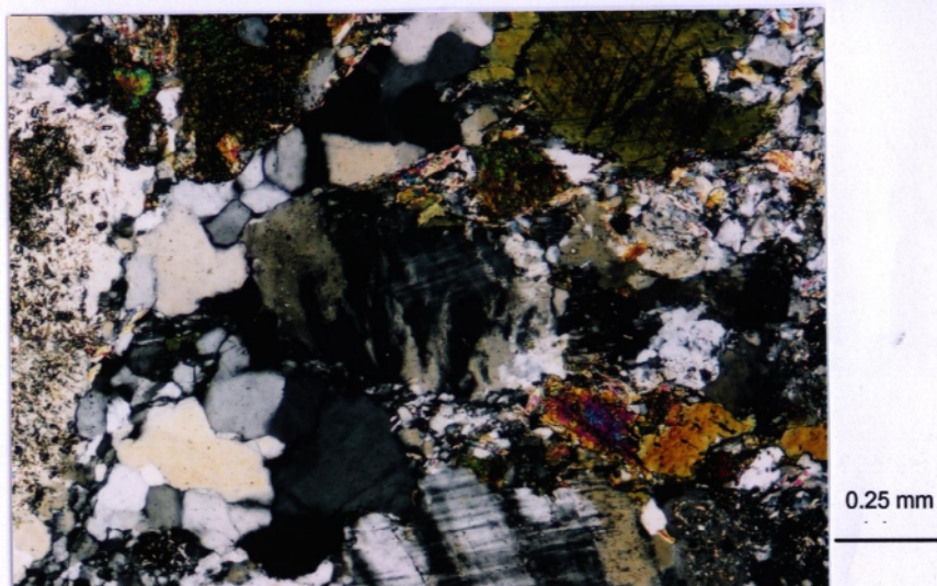
Foto 3.8: Aspecto geral da textura de um tonalito com afinidade granodiorítica, podendo observar-se, no canto superior direito, pseudomorfose seguindo biotite de clorite com agulhas de rútilo (nicóis cruzados). Amostra MS-19.
