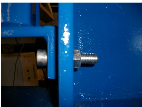
(c) Fixação do Pilar no suporte por parafusos
