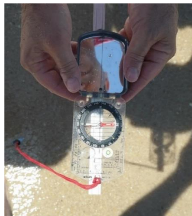
Figura 4.8: Bússola para medição do ângulo entre o sensor de temperatura do ECM e o norte magnético.
