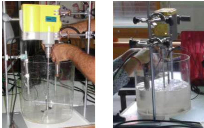
Figura 4.3: Estrutura utilizada para a calibração das sondas OBS (esquerda) e exemplificação da calibração (direita), (Calibração Carrilho, 2013).
