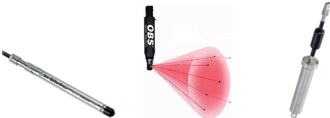
Figura 4.1: Instrumentos utilizados nas campanhas de campo, sensor de pressão (Fonte: Fondriest Environmental, Inc.), seguido de sensor ótico (Fonte: Campbell Scientific, Inc.) e por fim um correntómetro eletromagnético (Fonte: JFE Advantech Co., Ltd).
