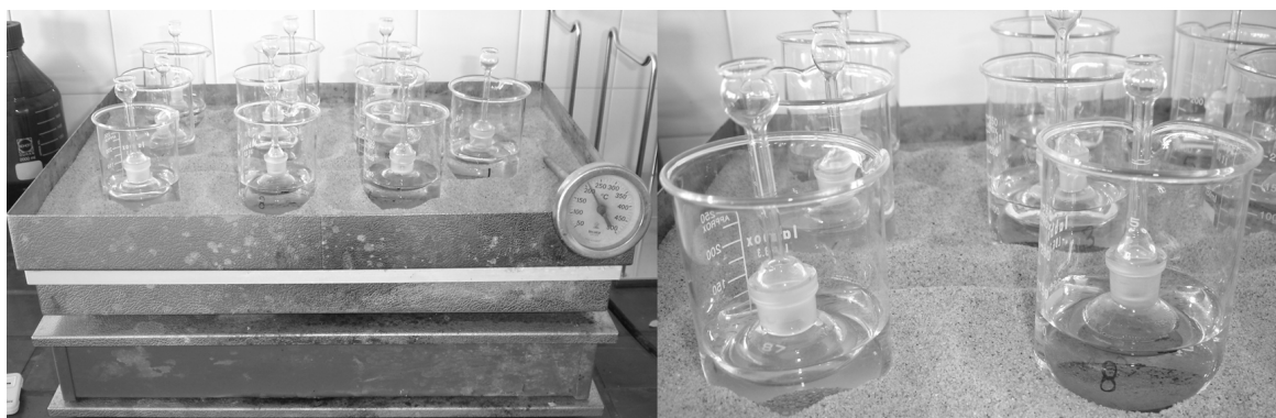
Figura 4.18 – Ensaios experimentais de determinação da massa volúmica verdadeira das cinzas.
