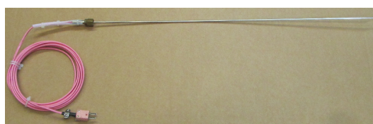
Figura 65 – Termopar tipo N (0...1250 °C) a introduzir na sonda de amostragem (cortesia Ventil – Engenharia do Ambiente, Lda.).
