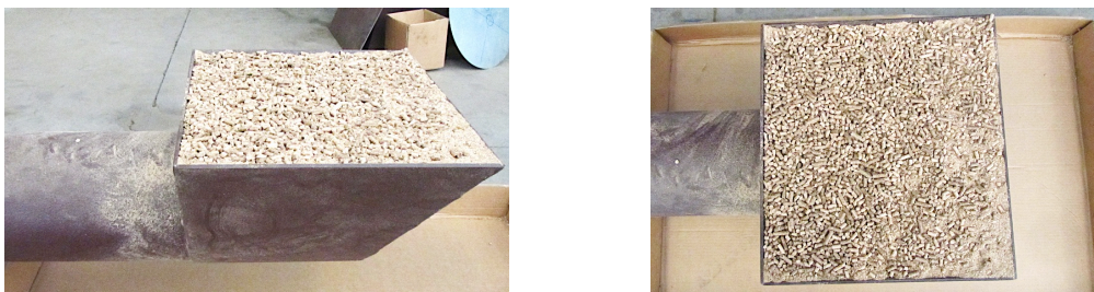
Figura 54 – Aspecto do cadinho da estrutura de prolongamento do sistema sem-fim preenchido com biomassa (Cortesia Ventil – Engenharia do Ambiente).
