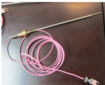
Figura 37 – Termopar tipo N (0...1250°C) para leitura de temperaturas ao longo do sistema de combustão (cortesia Ventil – Engenharia do Ambiente, Lda.).
