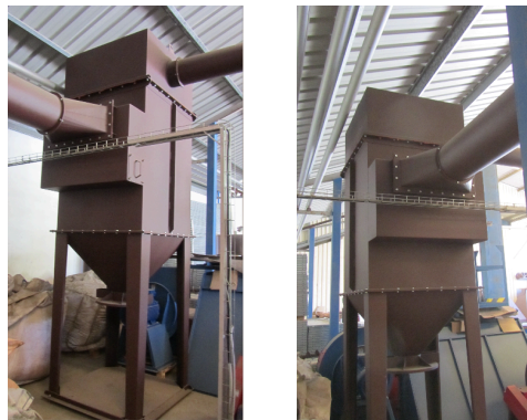
Figura 29 – Sistema de despoejamento – multiciclone (cortesia Ventil – Engenharia do Ambiente, Lda.).
