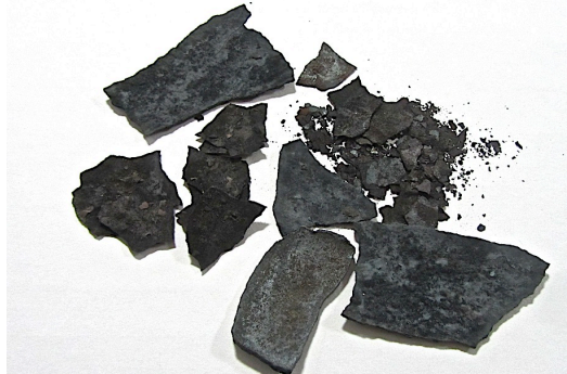
Figura 90 – Amostra recolhida nas paredes exteriores, localização na parte central inferior, de um pirolisador.
