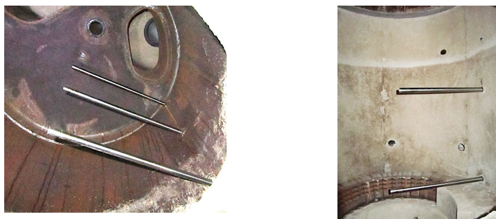
Figura 62 – Vista da posição das sondas de amostragem no interior das câmaras de combustão (cortesia Ventil – Engenharia do Ambiente, Lda.).
