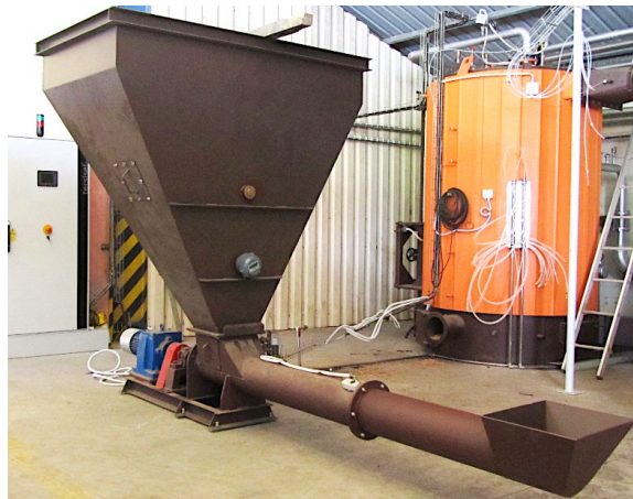
Figura 53 – Prolongamento da estrutura do sem-fim para simular as condições de combustão dentro do cadinho da fornalha (Cortesia Ventil – Engenharia do Ambiente).
