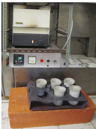
Figura 49 – Mufla para determinação do teor de matéria volátil; suporte e respetivos cadinhos.
