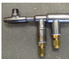
Figura 63 – Entrada e saída de água. fixação do termopar tipo N e extração de gases de combustão (cortesia Ventil – Engenharia do Ambiente, Lda.).
