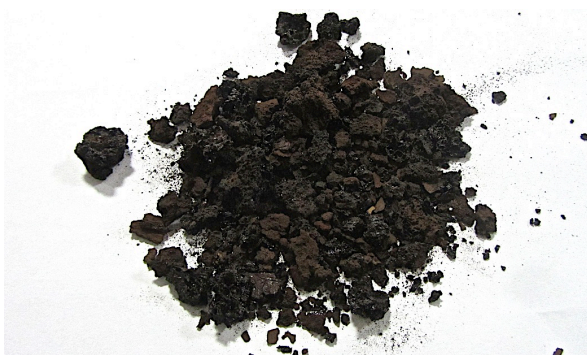
Figura 87 – Amostra recolhida no ventilador de um sistema de pirólise, com alimentação a pellets de bagaço de azeitona.
