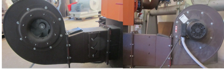
Figura 20 – Ventilador centrífugo RM 280 (cortesia Ventil – Engenharia do Ambiente, Lda.).
