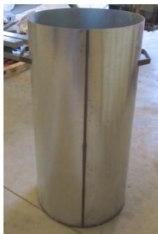
Figura 50 – Recipiente usado para a determinação da massa da biomassa (Cortesia Ventil – Engenharia do Ambiente).
