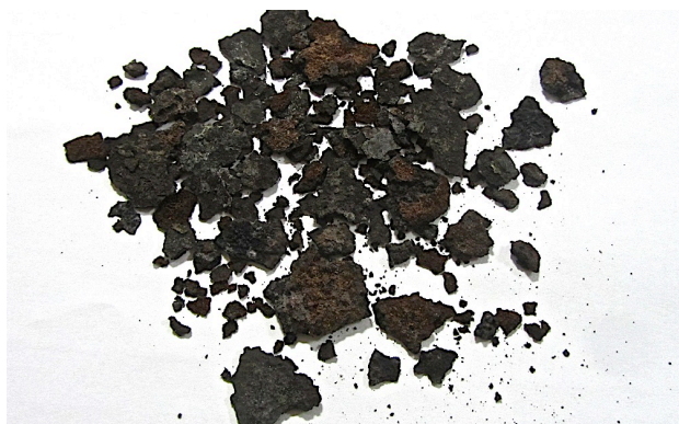
Figura 93 – Amostra recolhida nas paredes exteriores, localização na parte inferior, de um pirolisador
