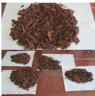
Figura 44 – Esquetejamento de amostras para obtenção de uma amostra teste representativa.
