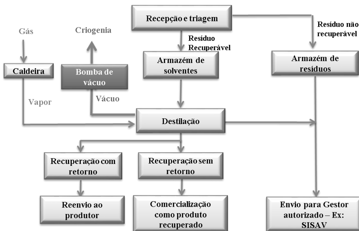
Figura 3: Diagrama simplificado do processo de receção, triagem, armazenamento, recuperação e expedição de solventes da EGEO Solventes S.A.
