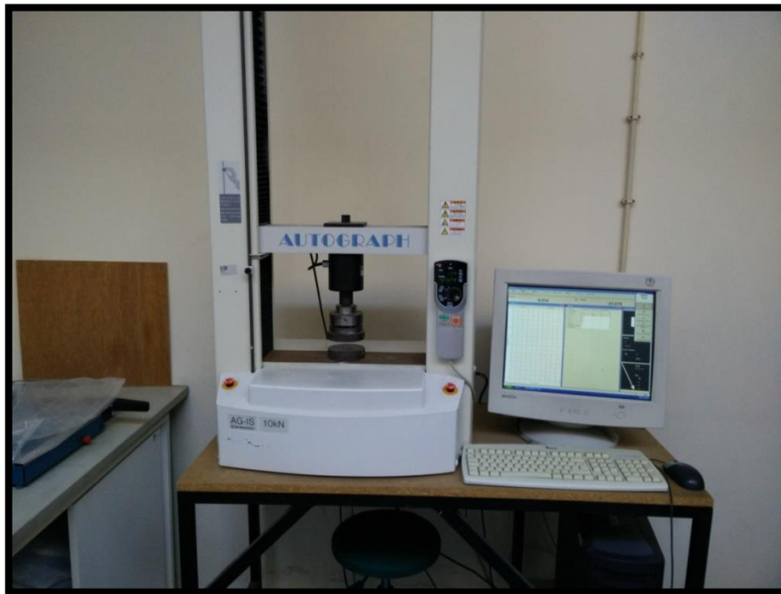
Figura 28 – Equipamento utilizado para realização dos ensaios mecânicos e respectiva célula de carga
