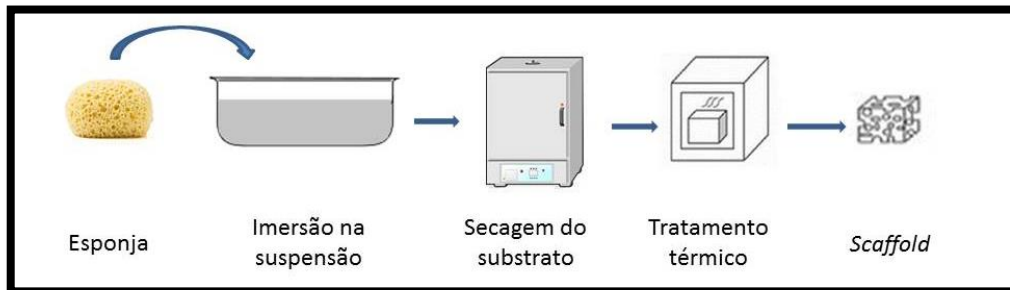
Figura 9 – Obtenção de scaffolds pelo método da esponja polimérica
