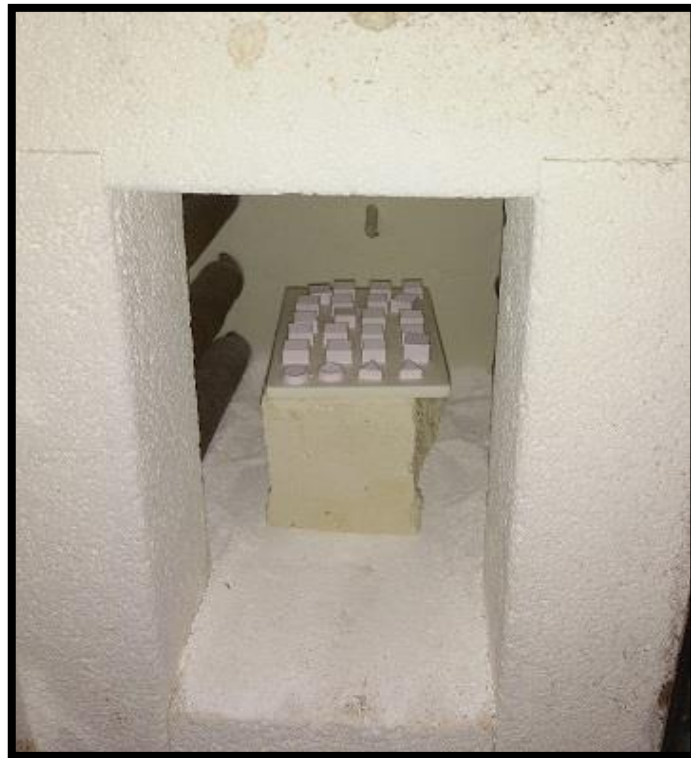
Figura 25 – Sinterização dos scaffold
