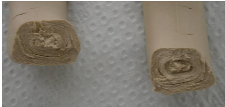
Figura 27 - Peças conformadas por enchimento por gravidade, evidenciando a orientação preferencial das partículas argilosas.
