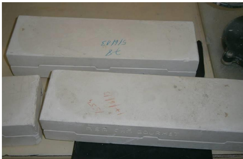
Figura 38 - Molde do tipo tablete apresentando alguma humidade absorvida.
