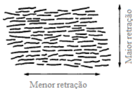
Figura 31 - Orientação de partículas argilosas e direções de retração.
