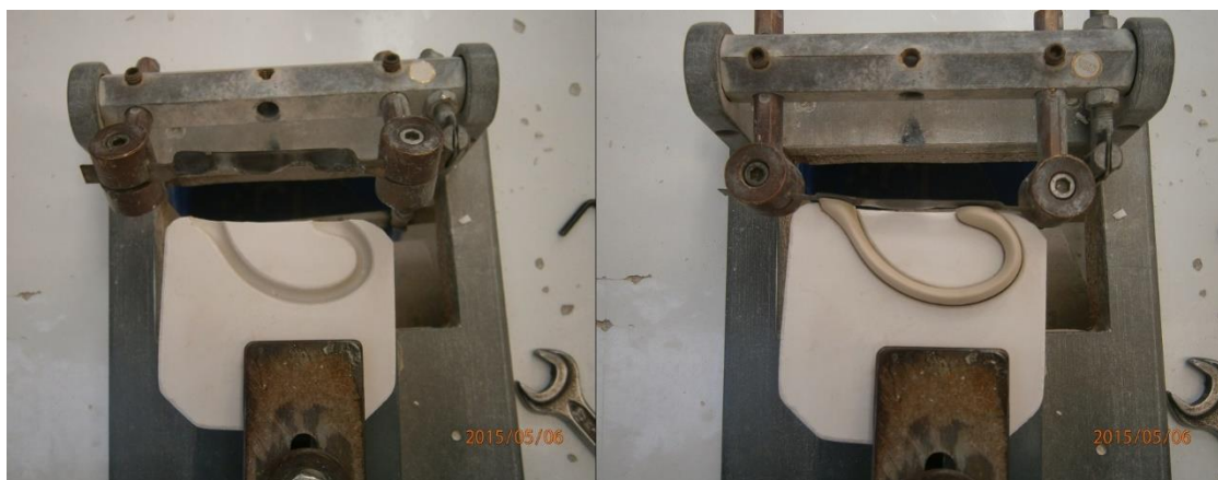
Figura 47 - Dispositivo de corte do excesso de material das asas
