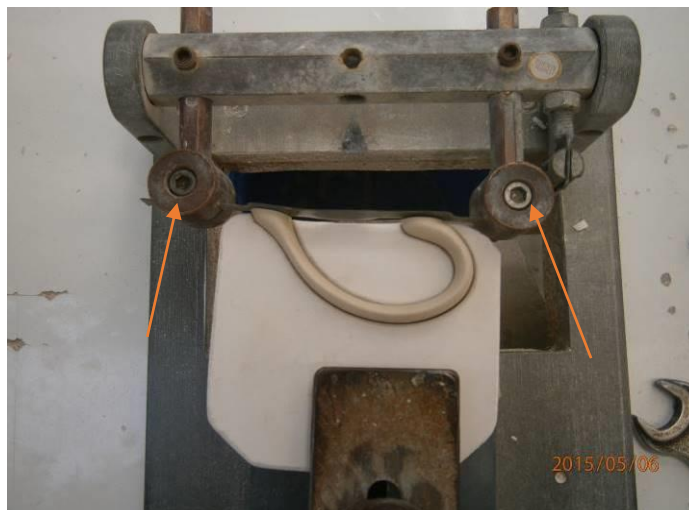
Figura 54 - Lâmina de corte de asas, posição em baixo. Parafusos de ajuste assinalados.
