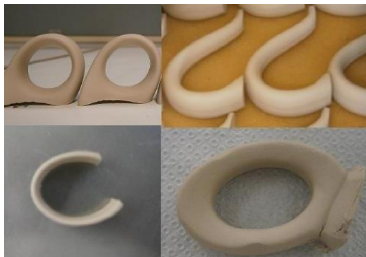
Figura 15 - Asas prontas a serem unidas com o corpo da chávena.
