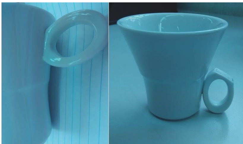
Figura 51 - Chávena com asa na posição correta (esquerda) e chávena com asa caída depois da cozedura (direita).
