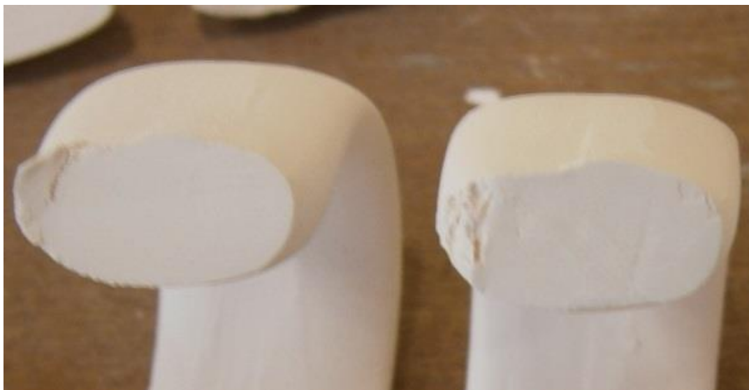
Figura 70 - Asas de enchimento manual com pasta PC, verificando-se a imperfeições de corte.
