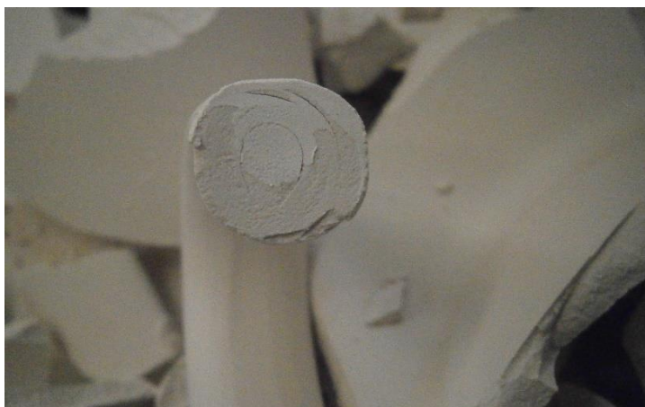
Figura 63 - Asa seca (pasta PT), evidenciando as fissuras originadas no enchimento.
