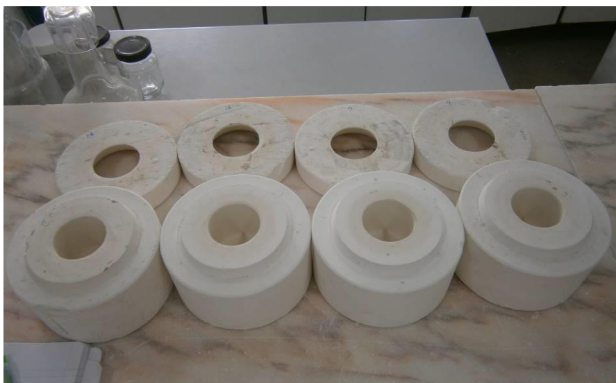
Figura 44 - Moldes utilizados no ensaio de velocidade de formação de parede
