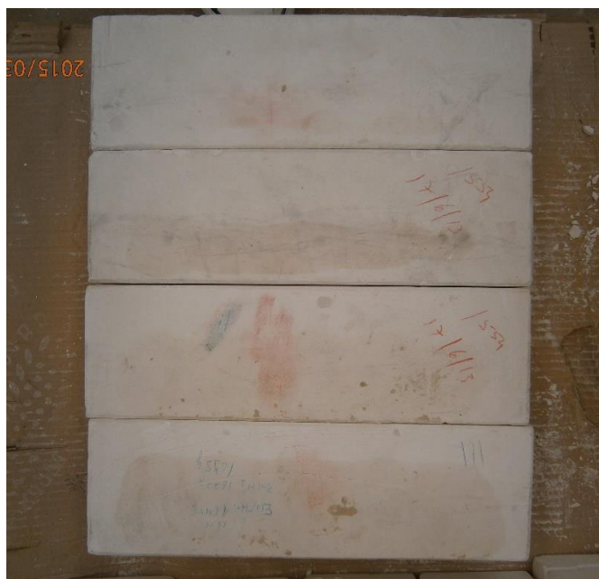
Figura 55 - Evolução da humidade contida nos moldes de gesso após os enchimentos.
