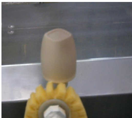
Figura 22 - Acabamento do corpo da chávena.
