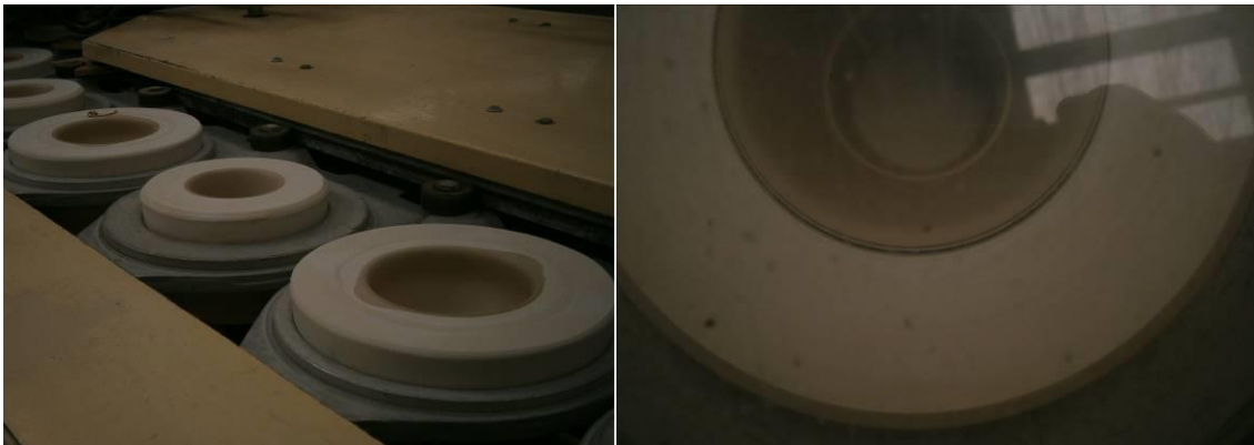
Figura 21 - Moldes de gesso na câmara de secagem da máquina roller .
