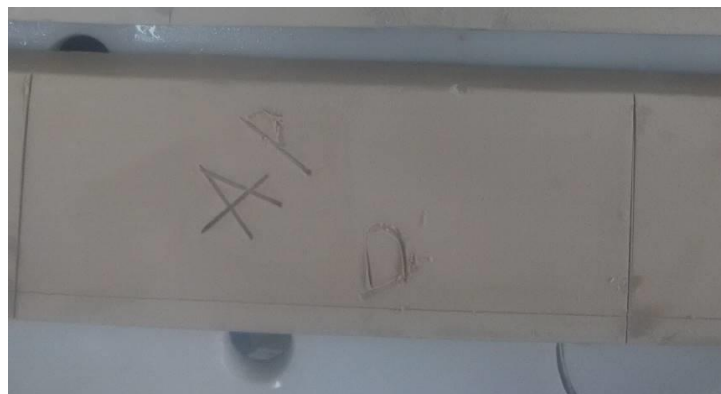
Figura 41 - Provete de pasta de porcelana para ensaio de Bigot.
