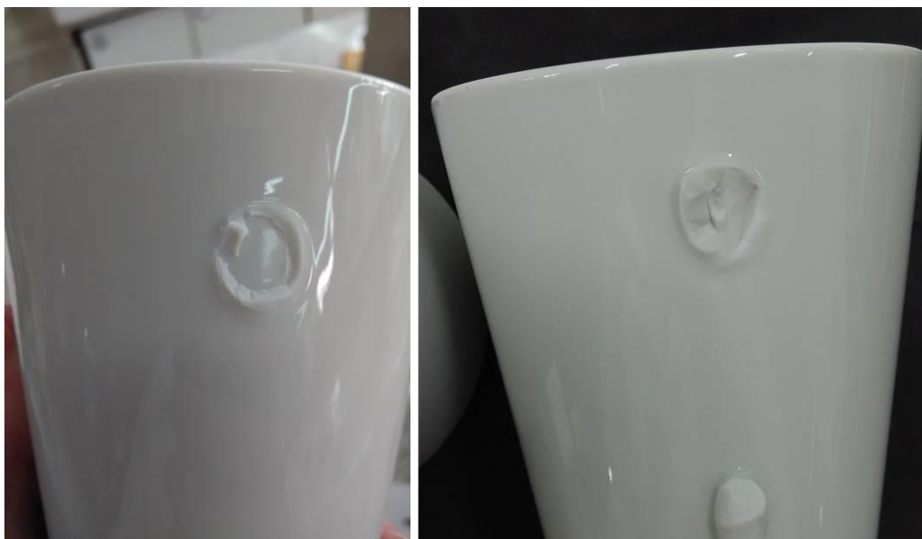
Figura 71 - Aspeto de zona de colagem da asa. Esquerda: pasta PT; direita, 60% olaria + 40% PT.
