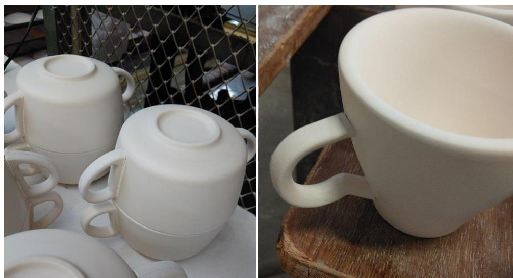
Figura 48 - Chávenas chocotadas com asas conformadas por alta pressão.
