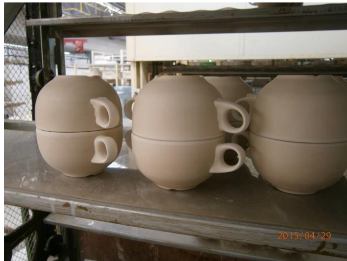
Figura 28 - Chávenas em transportadores do equipamento de secagem.
