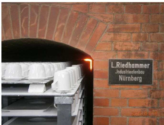
Figura 33 - Boca de saída do Forno 2.
