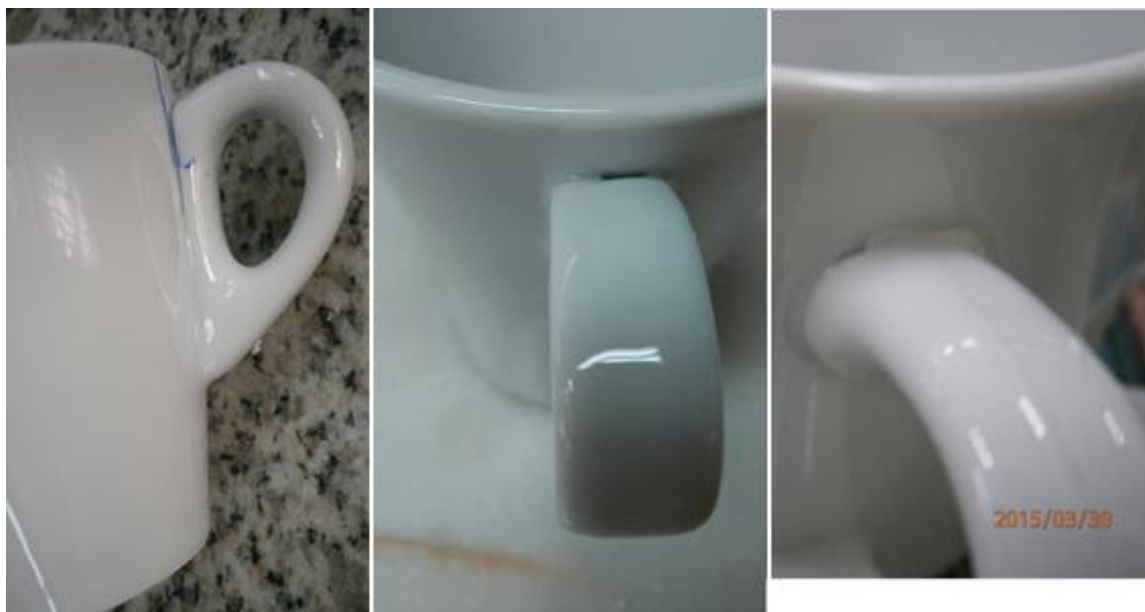
Figura 1 - Chávenas com descolamento parcial da asa.
