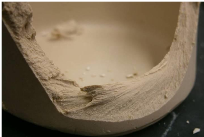
Figura 23 - Corte de uma peça em verde conformada por contramoldagem.
