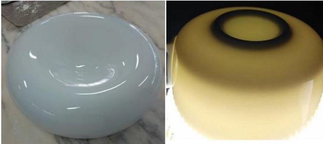
Figura 3 - Aspeto superficial e translucidez de um artigo de porcelana.
