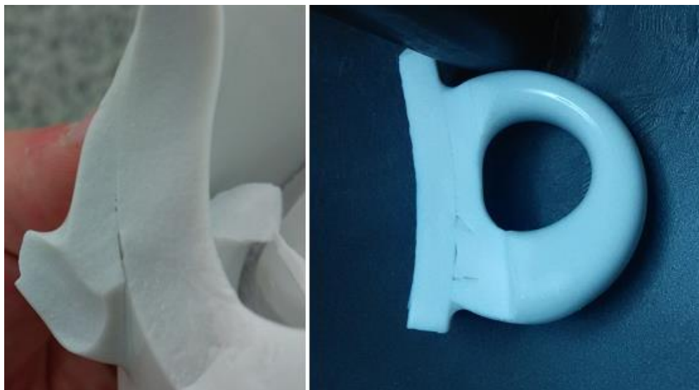
Figura 66 - Aspeto de asas conformada com pasta PC. Note-se a ausência ou baixa incidência de fissuras.
