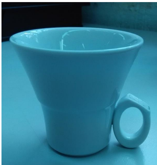
Figura 2 - Chávena com descolamento total da asa.
