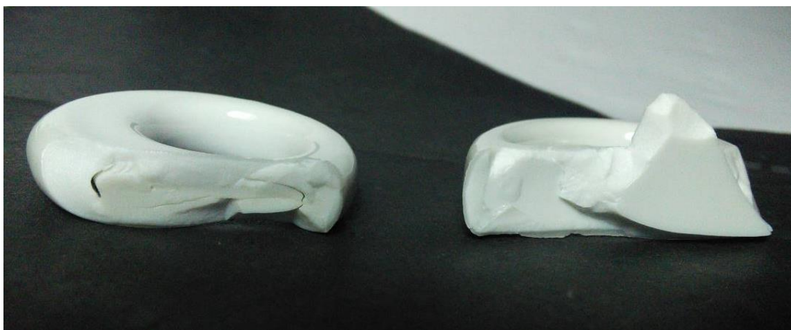
Figura 78 - Asa de enchimento tradicional e asa de enchimento por alta pressão. Verifica-se a ausência de fissuras na asa conformada por alta pressão
