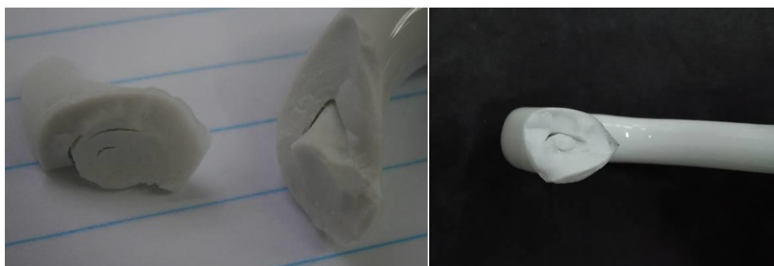
Figura 72 - Aspeto da asa. Esquerda: pasta PT; direita, direita, 60% olaria + 40% PT.
