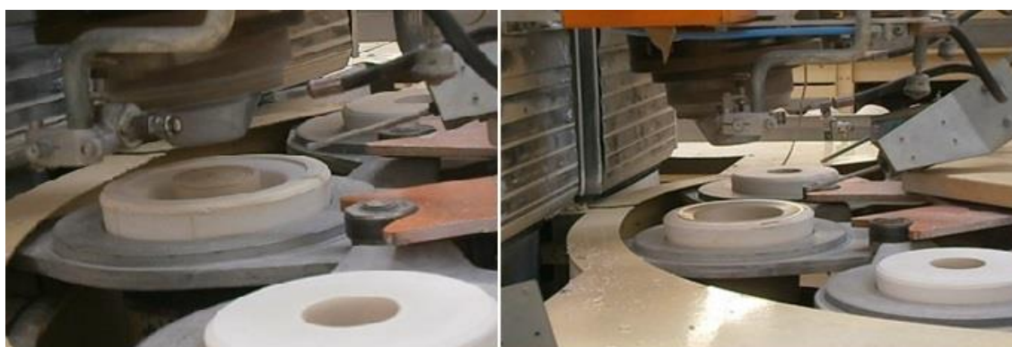
Figura 19 - Cabeça rotativa e molde de gesso, durante descida (esquerda) e após terminada a peça (direita).
