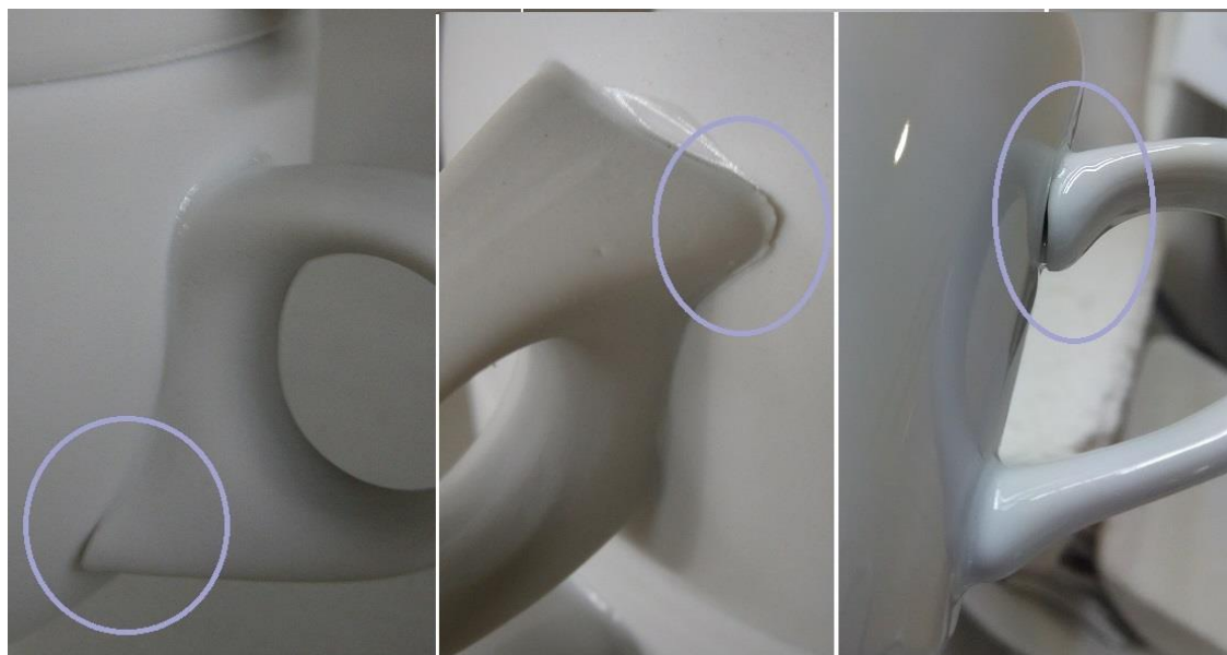
Figura 53 - Defeitos causados por corte inadequado na fase de acabamento da asa.
