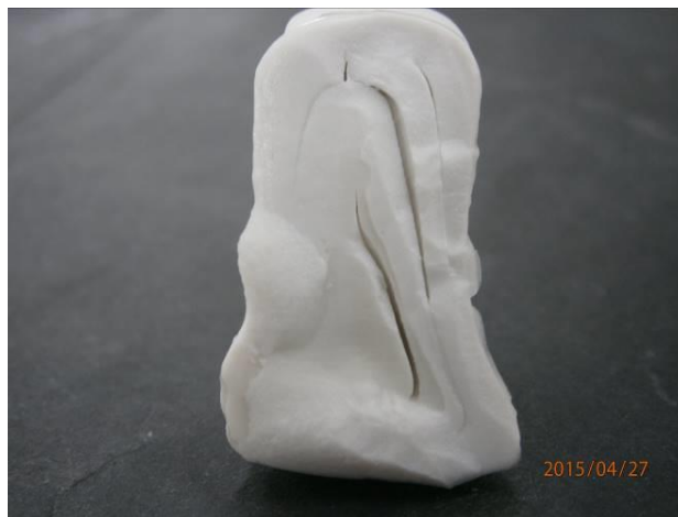
Figura 65 - Área de colagem de asa após cozedura (pasta PT).
