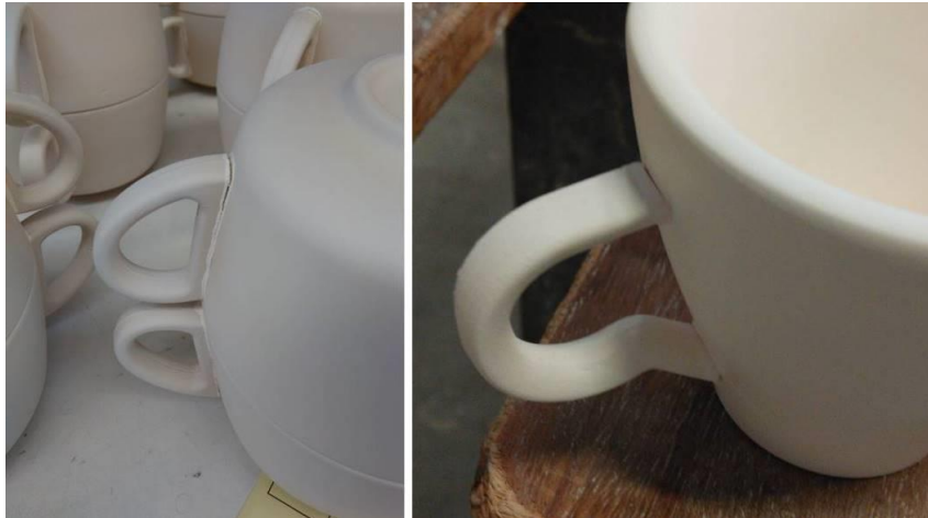
Figura 75 - Chávenas com asas conformadas por alta pressão.
