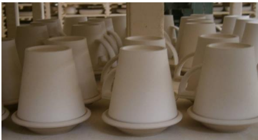
Figura 14 - Chávenas após a conformação colocadas em bases, prontas para chacotagem.
