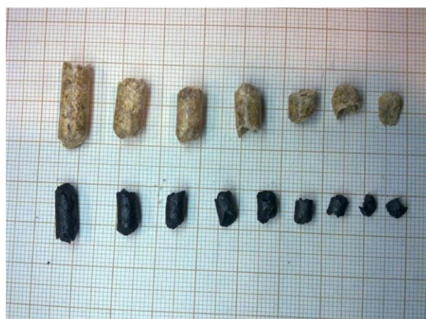
Figura 5.2 – Aspeto macroscópico (sobre papel milimétrico) das pellets de madeira originais e as respectivas partículas de carbonizado descarregadas do leito durante a gasificação deste tipo de biomassa (Tarelho et al. 2014).
