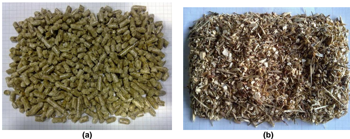
Figura 4.9 – Aspeto macroscópico (sob papel milimétrico) de (a) pellets de madeira do tipo comercial e (b) estilha de biomassa florestal residual derivada de pinheiro, usados nas experiências de gasificação (Tarelho et al. 2014).
