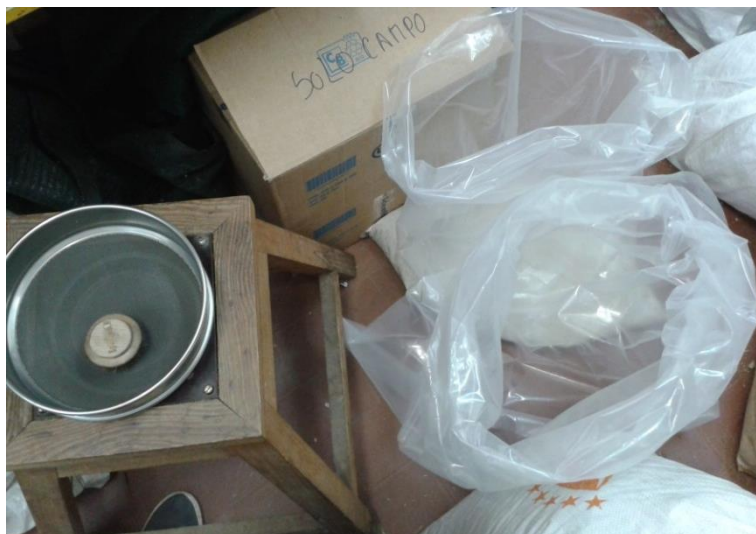
Figura 4.10 – Peneiração da areia do leito por crivagem manual.
