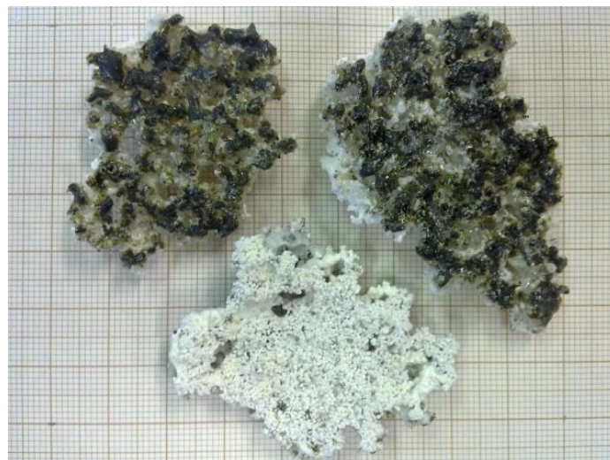
Figura 5.13 – Aspeto macroscópico, sobre papel milimétrico, de aglomerados retirados da superfície do leito, após o fenómeno de desfluidização ocorrido no decurso da gasificação de pellets de madeira (Tarelho et al. 2014).
