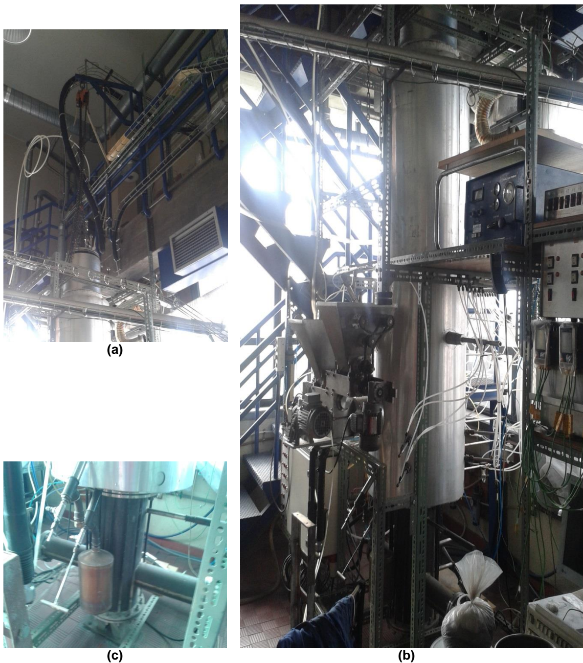
Figura 4.1 – Sistema experimental. Parte superior do reator de leito fluidizado, sistema de exaustão de gases (a); corpo do reator e sistema de alimentação de biomassa (b); parte inferior do reator, sistema de pré-aquecimento (c).
