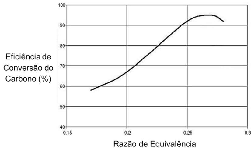
Figura 3.5 – Variação da eficiência de conversão do carbono com a razão de equivalência para um gasificador em leito fluidizado (Basu 2006).
