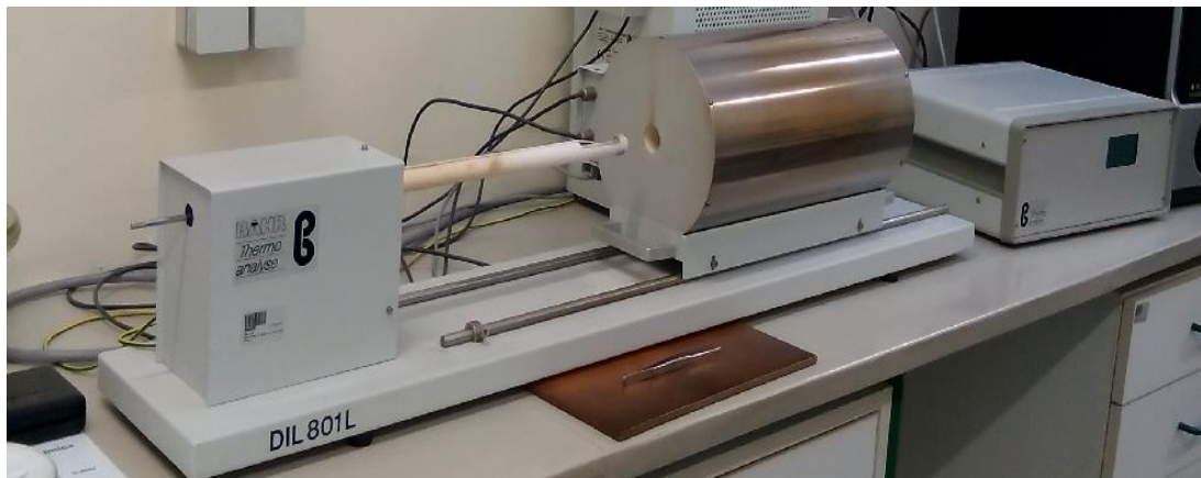
Figura II.3: Dilatômetro horizontal que trabalha em ar atmosférico, utilizado neste estudo.
