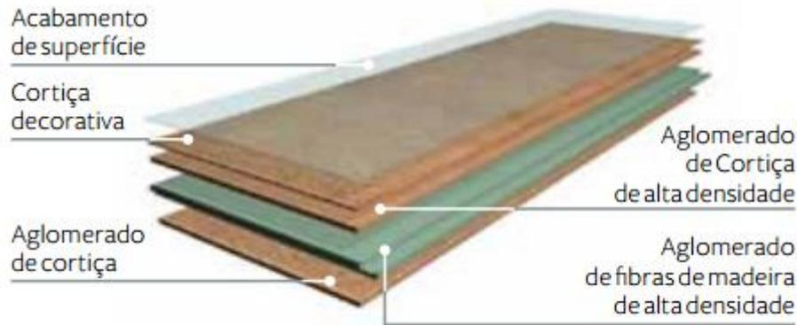
Figura 2. Constituição de um painel de piso flutuante em cortiça (Chiebao, 2011).
