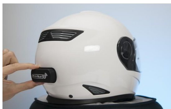
Figura 2.4 - Sistema do capacete - Rider-Ecall [14]
