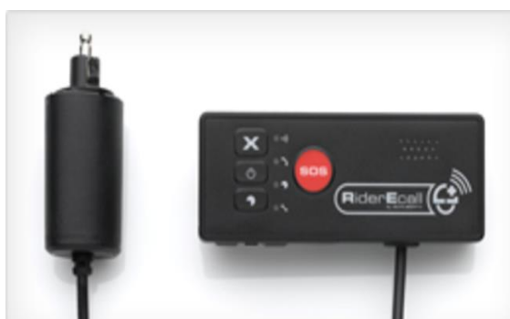
Figura 2.3 - Sistema do motociclo - Rider-Ecall [13]
