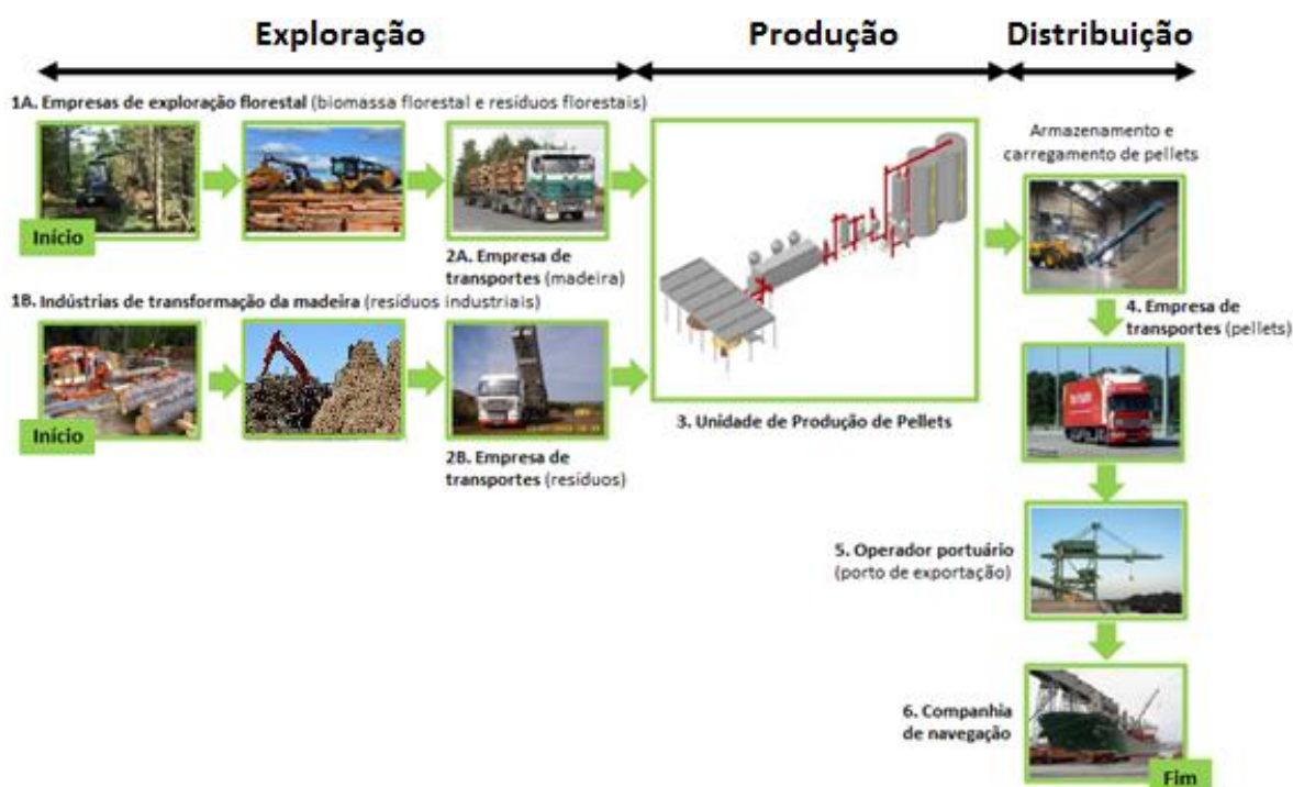
Figura 12 - Cadeia logística de biomassa para pellets (Fonte: Adaptado de (Bioenergy Portugal, n.d.)).
