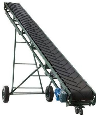
Figura 44 - Transportador de tela com declive (Fonte: (Indústria, 2013)).
