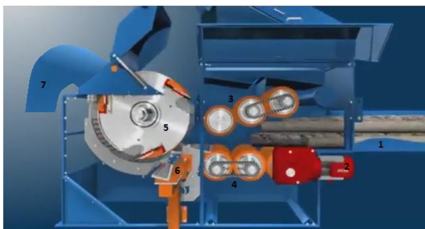
Figura 21 - Esquema de um estilhador de facas. 1 – Tapete rolante de alimentação; 2 – Motor e engrenagem; 3 – Rolos superiores de alimentação; 4 – Rolos inferiores de alimentação; 5 – Tambor com dispositivos de corte; 6 – Sistema de segurança; 7 – Sistema de descarga. (fontes: (Wood Fisrt, 2013b))
