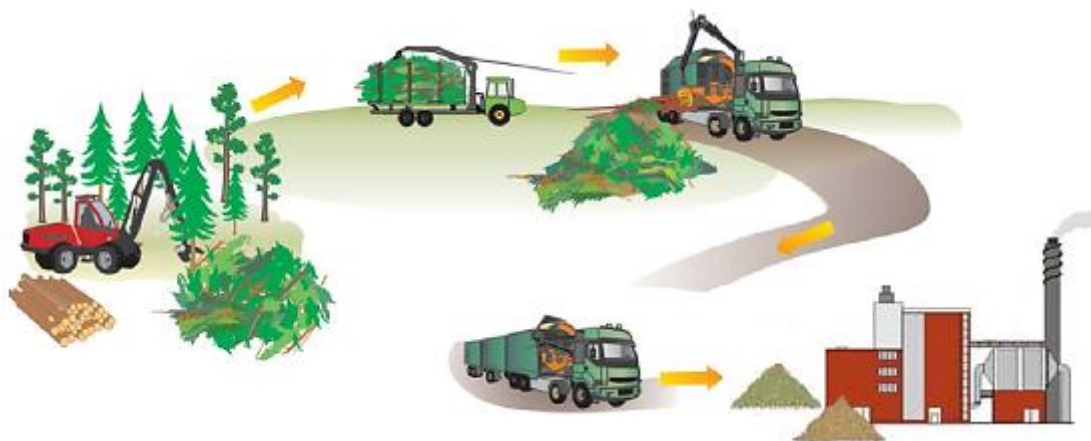
Figura 16 - Sistema de exploração florestal baseado no pré-tratamento efetuado no carregadouro, com recurso a um estilhador acoplado ao camião (Fonte: Adaptado de (Hakkila, 2004).
