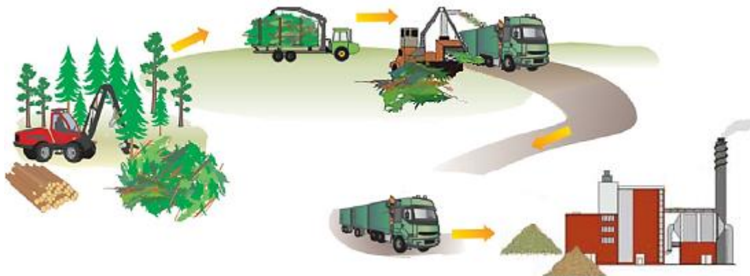
Figura 15 - Sistema de exploração florestal baseado no pré-tratamento efetuado no carregadouro, com recurso a um estilhador fixo (Fonte: Adaptado de (Hakkila, 2004).
