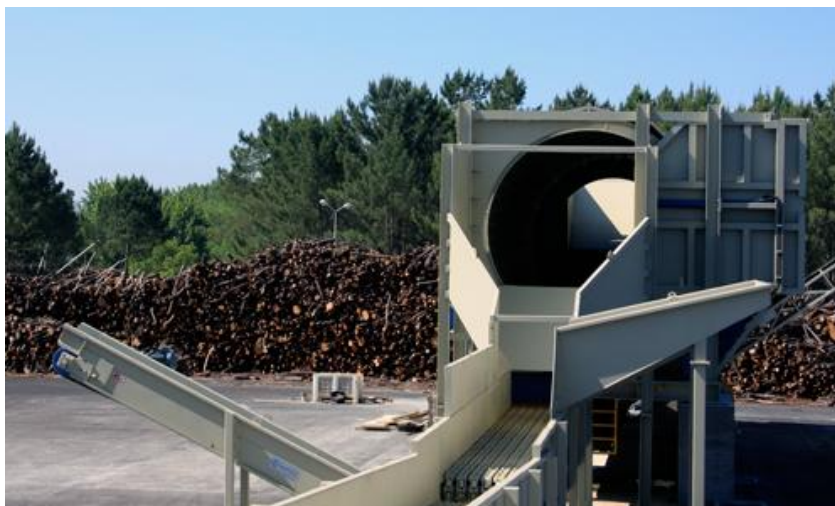
Figura 20 - Exemplo de um estilhador de martelos. (Fonte: (Enerpellets, 2013a))
