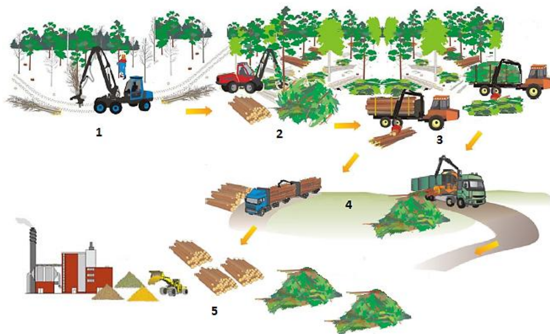
Figura 13 - Sistema de exploração de biomassa florestal em natureza (Fonte: Adaptado de (Hakkila, 2004)).
