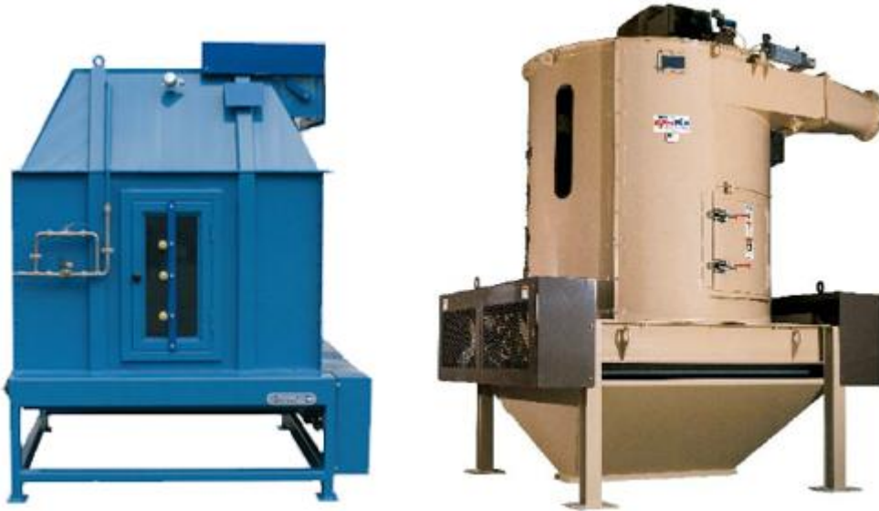
Figura 37 - Arrefecedor vertical com câmara retangular, à direita, e câmara circular à esquerda (Fonte: (Feelwarm, 2013; Bliss Industries, 2010)).
