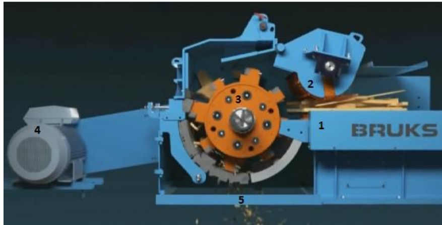
Figura 22 - Esquema de um estilhador de martelos. 1 – Tapete rolante de alimentação; 2 – Rolo superior de alimentação; 3 – Tambor com dispositivos de destroçamento; 4 – Motor e engrenagem; 5 – Sistema de descarga. (Fonte: (Wood Fisrt, 2013b))
