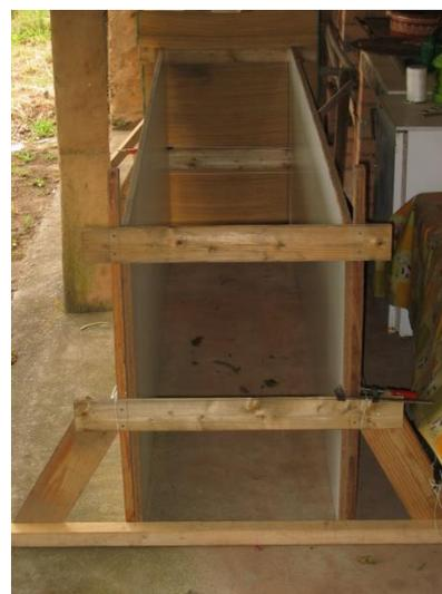
*Figura 9 - Caixa utilizada no ensaio de compressão.*
