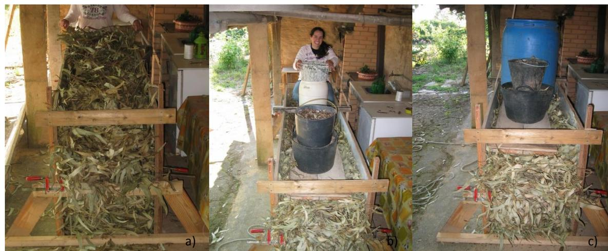
Figura 23 - Vários estágios do ensaio de compressão. a) Após a primeira carga de BFR. b) Aumento da força aplicada à superfície da caixa c) Pilha de biomassa após a última compressão.
