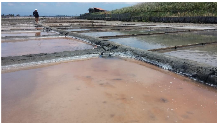
Figura 16: Fotografia da coloração avermelhada da salmoura nos evaporadores da marinha-velha, tirada no dia 07.07.2015
