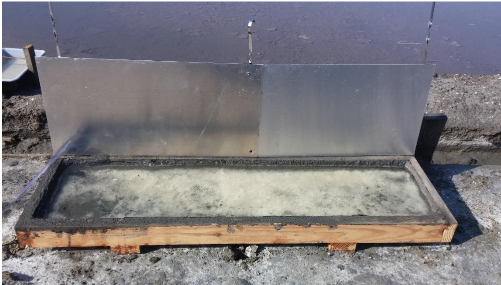
Figura 25: Fotografia da montagem experimental do Protótipo de madeira com a placa refletora
