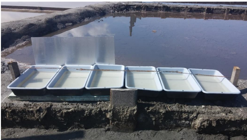
Figura 23: Fotografia da montagem experimental dos tabuleiros plásticos, com placa refletora nos três primeiros tabuleiros
