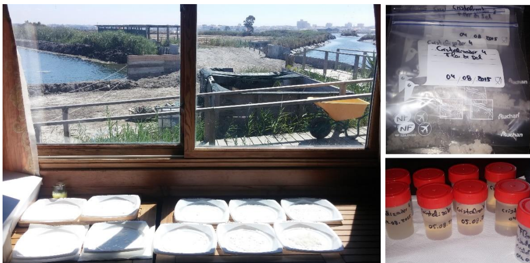
Figura 22: Fotografias do sítio de secagem das amostras recolhidas, dos sacos onde foram guardadas as amostras e dos frascos de recolha das amostras de salmoura
