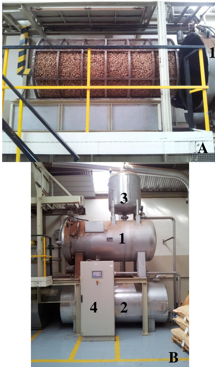
Fig. 14- Equipamento industrial do processo INOS II. (A) Tambor de rede de alimentação de rolhas. (B) Processo de desinfecção INOS II; (1) Câmara das rolhas, (2) Reservatório da água, (3) Câmara de transição entre a câmara das rolhas e os tubos de ar comprimido, vácuo e ar atmosférico, (4) Monitor de controlo do equipamento industrial.
