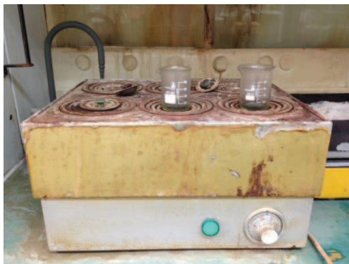
Figura 41 – Secura das amostras no banho a 100°, equipamento existente no laboratório da Celbi (fotografia obtida com permissão da empresa).
