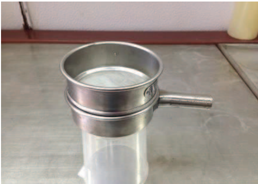
Figura 35 - Peneiro de fibras, equipamento existente no laboratório da Celbi (fotografia obtida com permissão da empresa).
