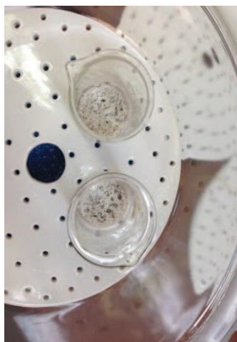
Figura 40 – Amostras em cinzas, após queima na mufla (fotografia obtida com permissão da empresa).
