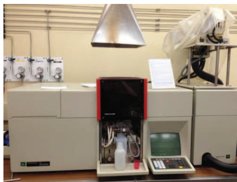
Figura 42 –Espectrómetro de absorção atômica, equipamento existente no laboratório da Celbi (fotografia obtida com permissão da empresa).
