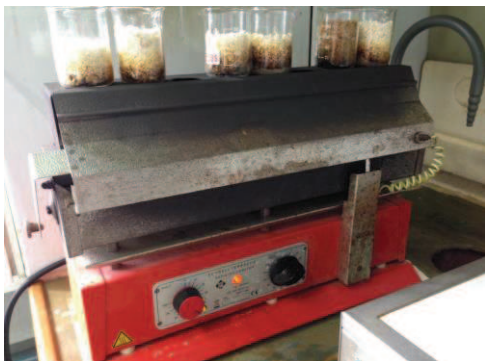
Figura 37 – Incineradora, equipamento existente no laboratório da Celbi (fotografia obtida com permissão da empresa).
