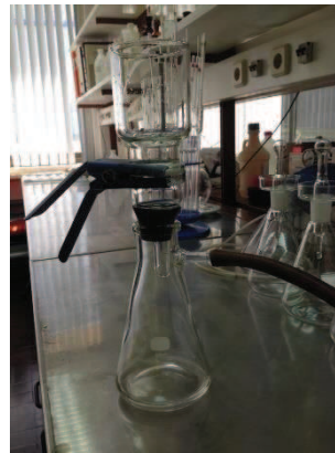
Figura 36 – Filtração com papel Milipore, equipamento existente no laboratório da Celbi (fotografia obtida com permissão da empresa).
