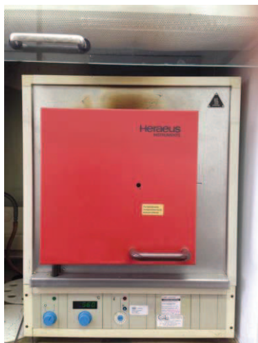
Figura 39 – Mufla, equipamento existente no laboratório da Celbi (fotografia obtida com permissão da empresa).
