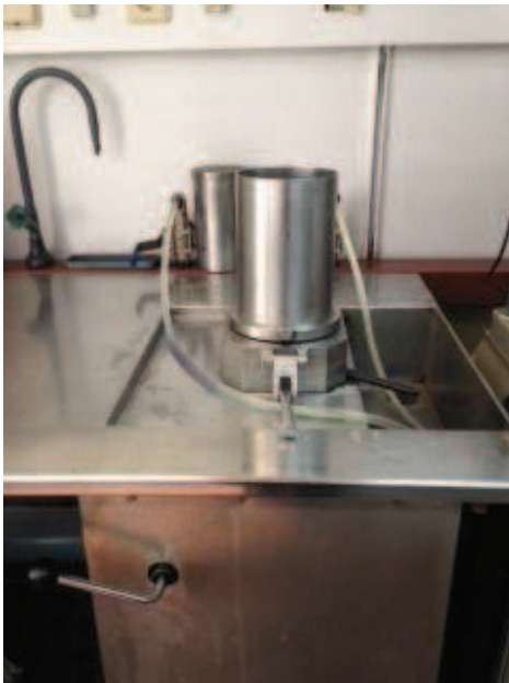
Figura 28 – Formador de folhas, equipamento existente no laboratório da Celbi (fotografia obtida com permissão da empresa).
