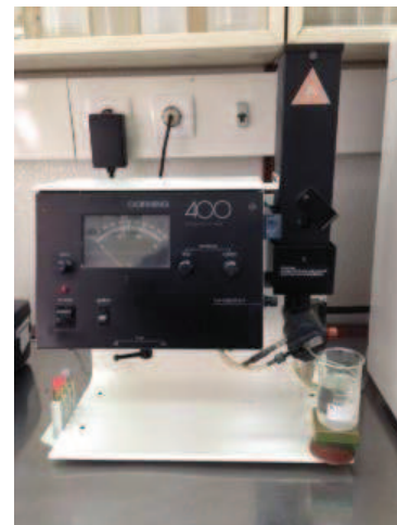
Figura 33 - Fotómetro de chama, equipamento existente no laboratório da Celbi (fotografia obtida com permissão da empresa).
