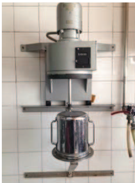
Figura 30 - Desfibrador de pasta, equipamento existente no laboratório da Celbi (fotografia obtida com permissão da empresa).
