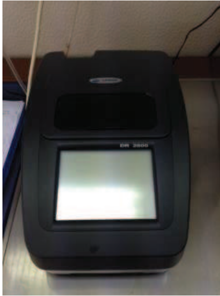
Figura 31 – Espectrofotómetro Lange equipamento existente no laboratório da Celbi (fotografia obtida com permissão da empresa).
