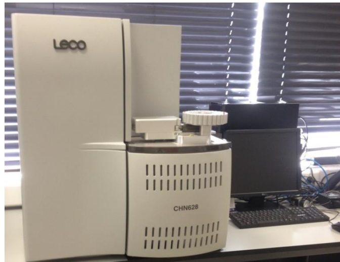
Figura 3.10 - Analisador elementar de carbono, hidrogénio e azoto da marca LECO , modelo CHN628 .
