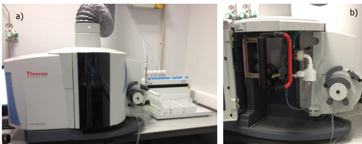
Figura 3.8 - ICP-OES. a) Vista geral do equipamento com o autosampler; b) Vista interna.
