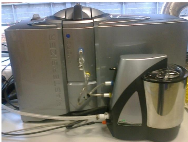
Figura 3.16 - Mastersizer 3000 da Malvern com acessório HYDRO e respectivo tanque de dispersão.
