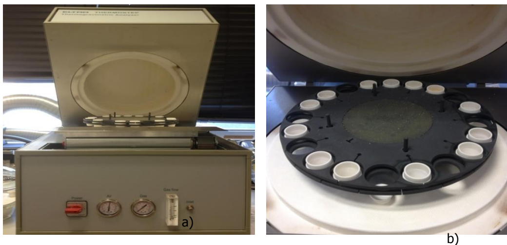
Figura 3.7 - TGA da marca ELTRA , modelo Thermostep ; a) vista geral; b) carrssel com cadinhos em cerâmica.
