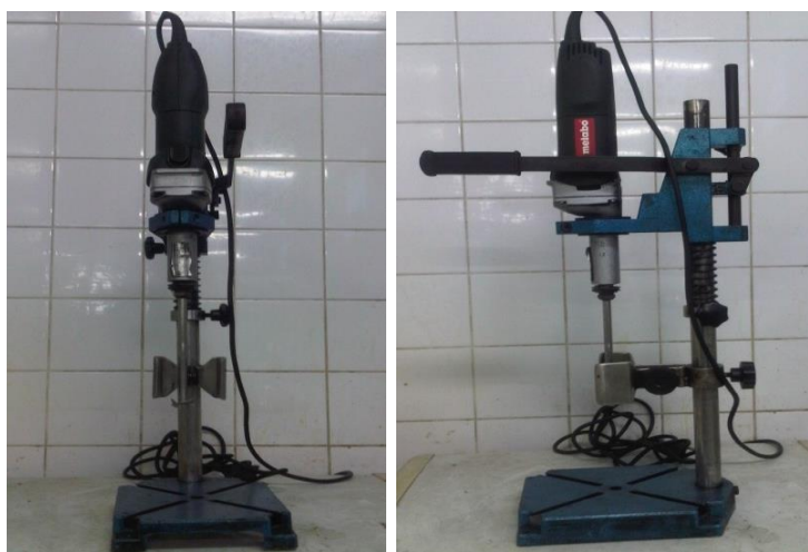
Figura 3.17 - Homogeneizador adaptado, da marca Metabo , modelo GE 900 Plus , com hélice de 3 cm de diâmetro.
