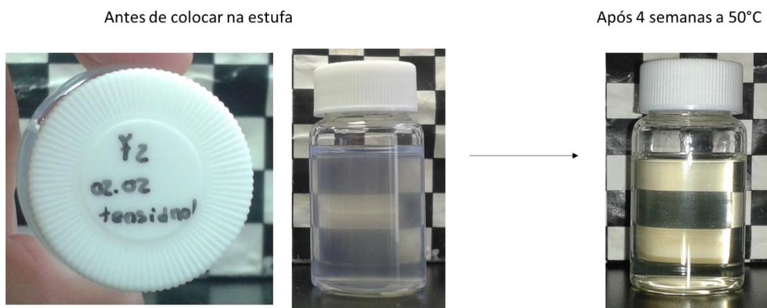
Figura 2 - Aparência macroscópica da F2 com Tensidrol, à esquerda à temperatura ambiente e à direita após 4 semanas na estufa a 50°C.
