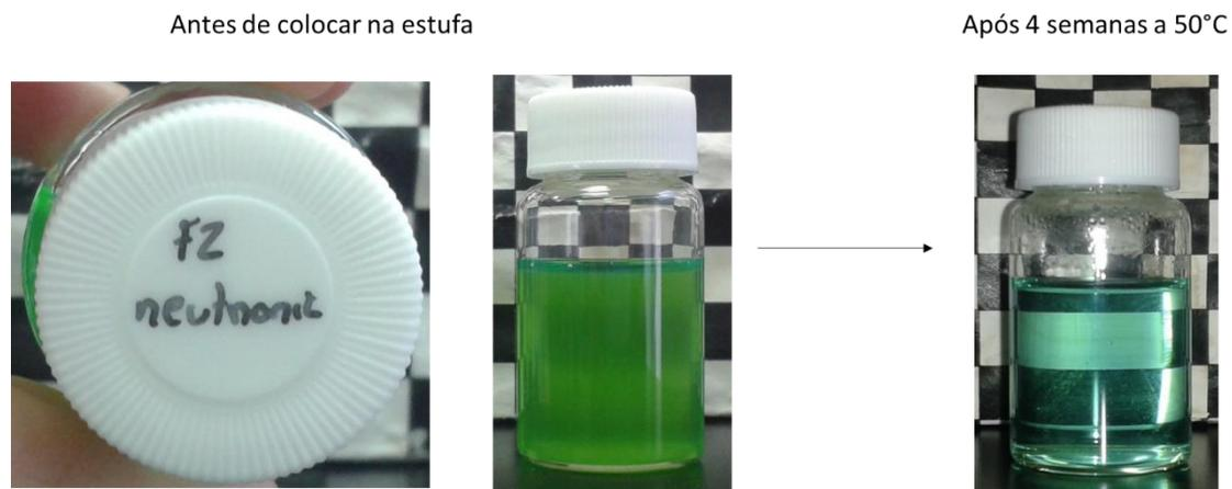
Figura 10 - Aparência macroscópica da F2 com Neutronic, à esquerda à temperatura ambiente e à direita após 4 semanas na estufa a 50°C.
