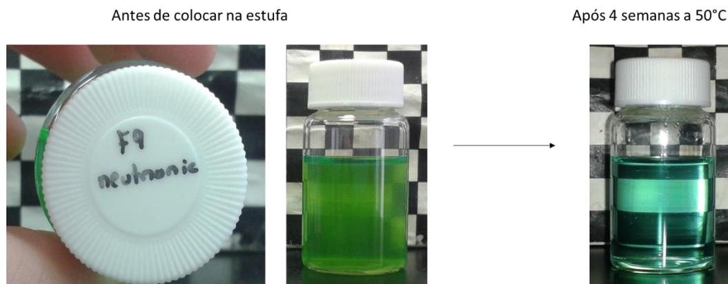
Figura 54 - Aparência macroscópica da F9 com Neutronic, à esquerda à temperatura ambiente e à direita após 4 semanas na estufa a 50°C.
