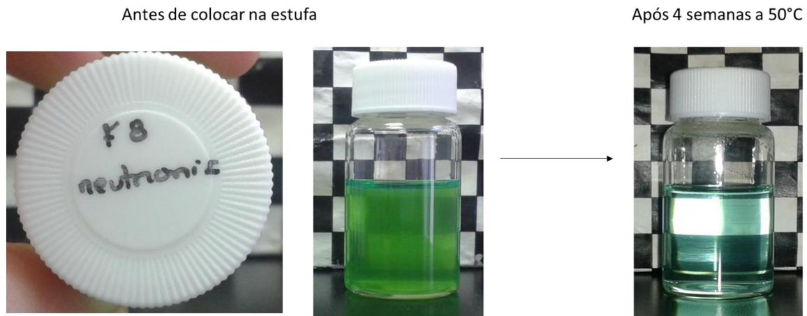
*Figura 16* - Aparência macroscópica da F8 com Neutronic, à esquerda à temperatura ambiente e à direita após 4 semanas na estufa a 50°C.
