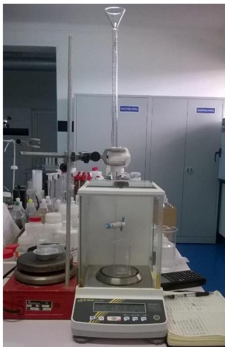
*Figura 38* -Montagem experimental para a determinação da tensão superficial pelo método do peso da gota.
