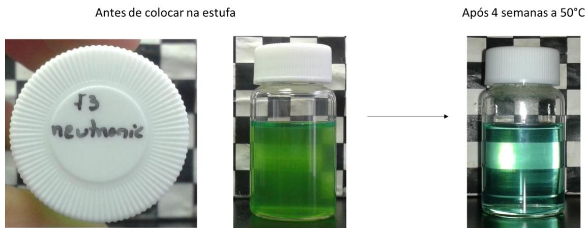
Figura 11 - Aparência macroscópica da F3 com Neutronic, à esquerda à temperatura ambiente e à direita após 4 semanas na estufa a 50°C.
