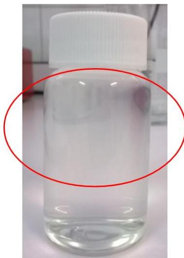
*Figura 47* - Exemplo da aparência visual do *Cloud Point*, numa das fórmulas testadas. Assinalado dentro de um círculo vermelho está a formação da nuvem que ascende à parte superior do frasco, resultado da formação de agregados de micelas.
