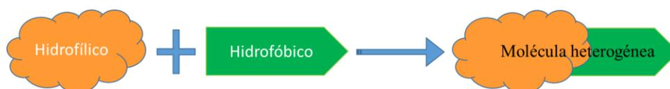
Figura 3 – Esquema elucidativo da natureza heterogênea de um tensoativo. A fração laranja da molécula é responsável pela carga que a molécula apresenta ou não.<sup>6</sup>
