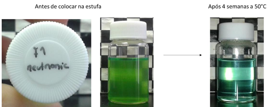
Figura 9 - Aparência macroscópica da F1 com Neutronic, à esquerda à temperatura ambiente e à direita após 4 semanas na estufa a 50°C.
