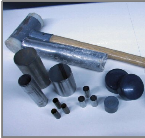
Figura 3.3 Material para a colheita de amostras para determinações por luminescência: tubos de inox vedados à luz, de diferentes dimensões.
