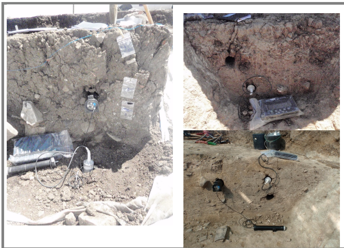
Figura 4.14. Equipamentos de medida HPI Rainbow MCA e Target Nanospec com sondas com cristais de NaI de 2" x 2".
