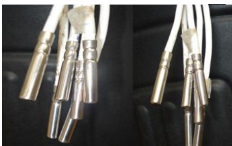
Fig. 20. Conjunto operativo de 12 sondas PT100.
