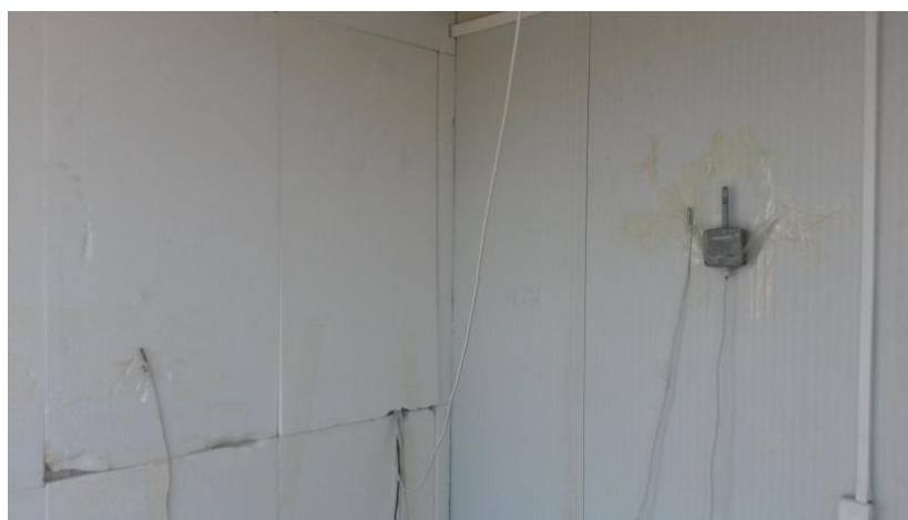
Fig. 21. Posicionamento da sonda de temperatura e humidade relativa interior JUMO 907021/21 e de sondas PT100 no compartimento experimental.
