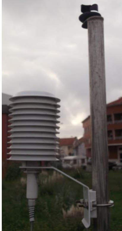
Figura 17 - Sonda HD 9008 TR na célula de teste
