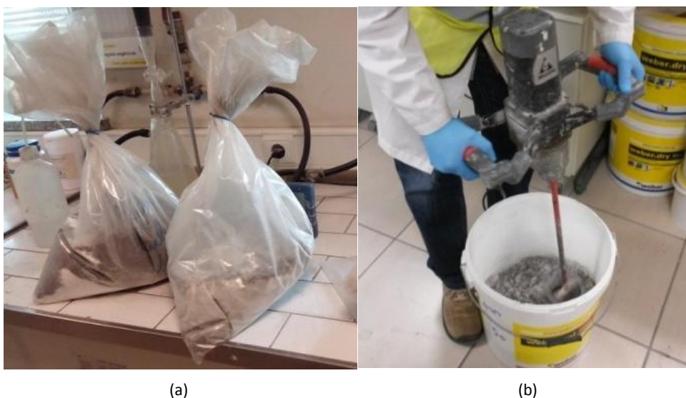
Figura 10 – (a) Mistura dos materiais constituintes da argamassa; (b) amassadura da argamassa com PCM através da misturadora
