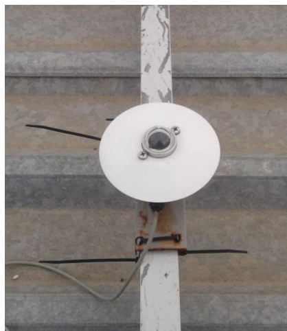
Figura 18 - Piranómetro LP PYRA da Delta Ohm na cobertura da célula de teste
