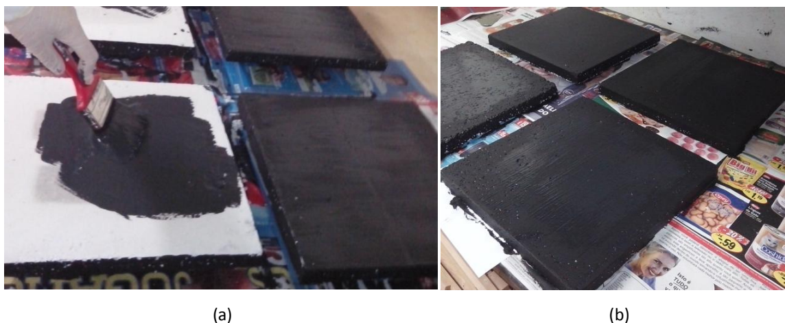
Figura 13 – Lajetas com tinta preta CIN Vinylmatt (a) durante a pintura e (b) após a pintura
