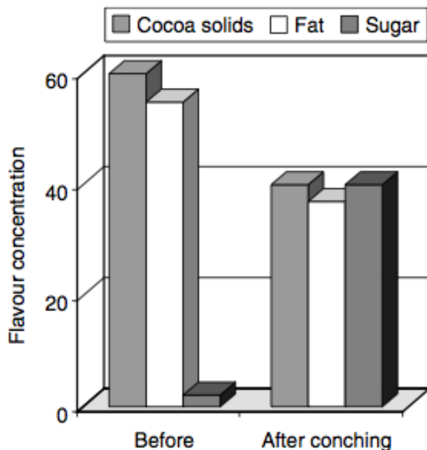
Figura 4 – Distribuição de flavour entre os sólidos de cacau, a superfície das partículas de açúcar e a gordura, antes e depois da conchagem. 13
