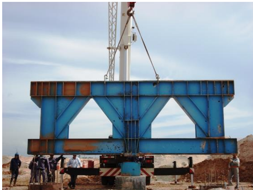
[1] Instalação do sistema de medição do ensaio de carga (fonte: GEO, 2009 [3:4]).
