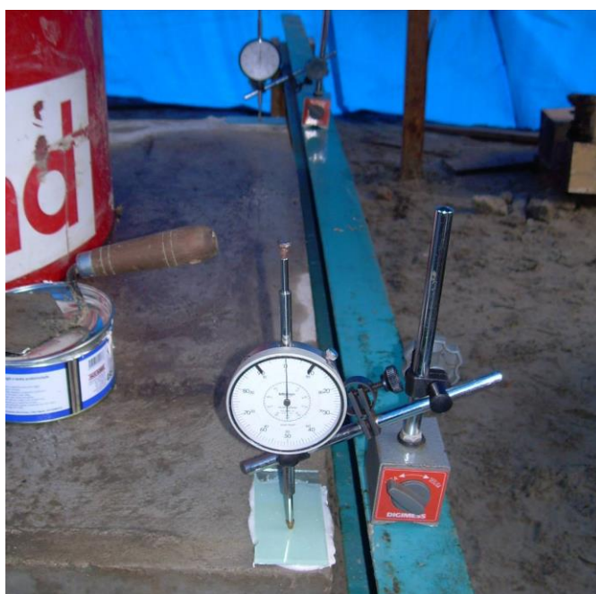
[3] Sistema de medição do ensaio de carga (fonte: GEO, 2010 [3:16]).
