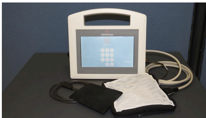
Figura 34: Protótipo do dispositivo médico destinado à Eletropeloterapia, o qual inclui o protótipo desenvolvido, o eléctrodo de retorno e o display para monitorização do programa a aplicar.
