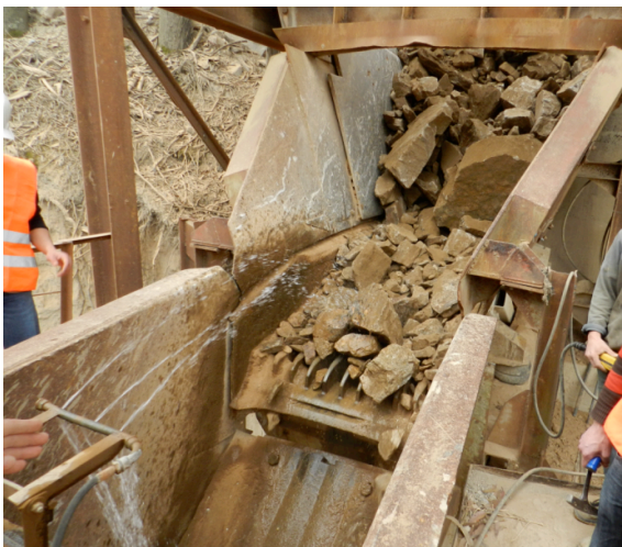
Figura 40: Britador de maxilas a ser alimentado pela torva (imagem de Bruno Soares).
