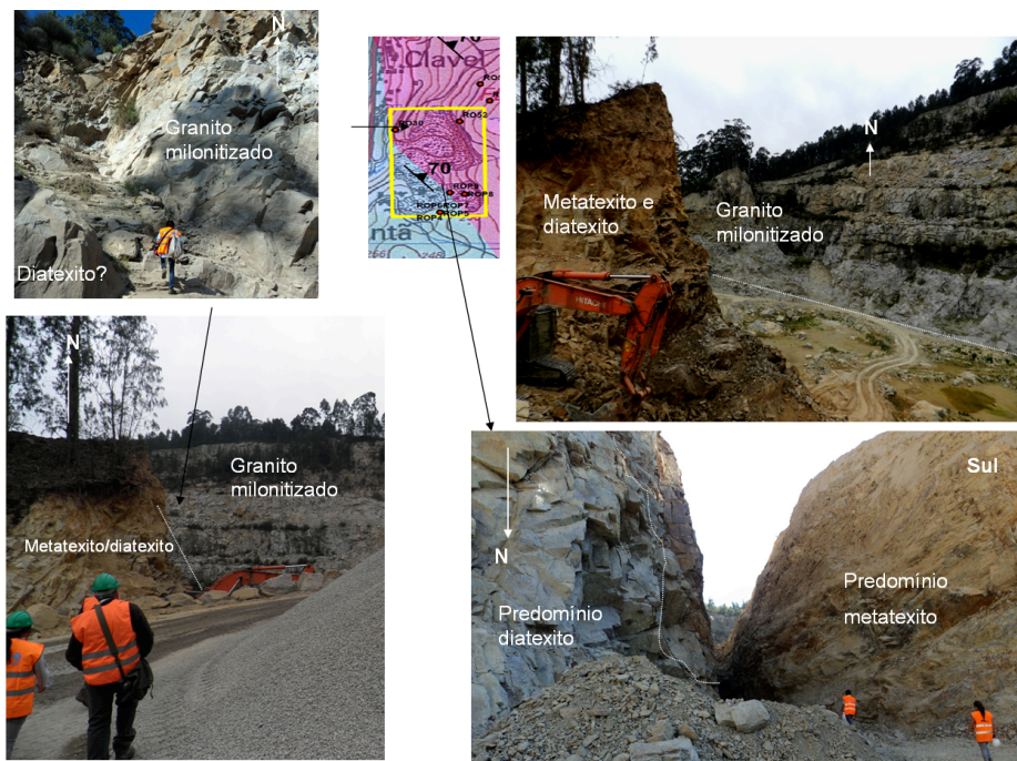
Figura 30: Fotografias dos afloramentos da Pedreira Sacramento (ano 2012) com a classificação das litologias aflorantes e a marcação da orientação geral dos limites gradativos entre as litologias (linhas brancas a tracejado).
