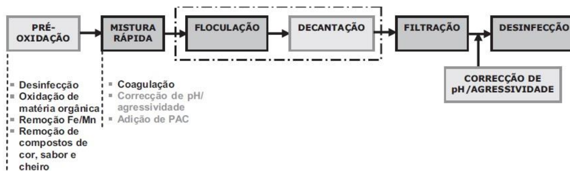
Figura 1.4 - Esquema tipo de tratamento de água de origem superficial [10].
