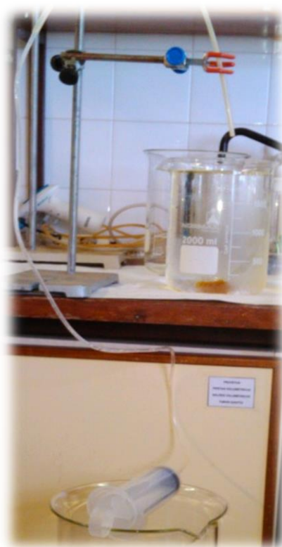
Figura 3.5 - Recolha do sobrenadante com a técnica de sifão.
