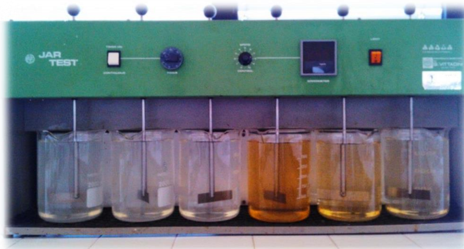
Figura 3.3 – Aparelho de Jar-Test realizando a mistura lenta, com os coagulantes de sulfato de alumínio (três jarros da esquerda) e cloreto de ferro (três jarros da direita).
