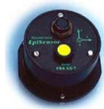
Figura 2.16 - Acelerómetro force-balance : Modelo Kinemetrics FBA ES-T (Pimentel, 2008).
