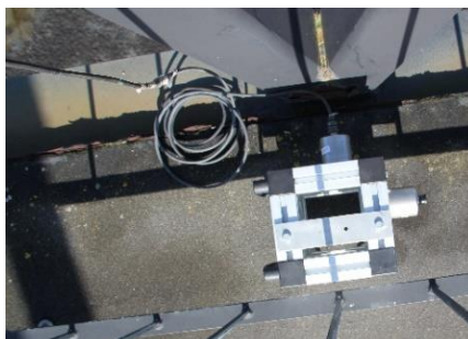
Figura 6.14 - Cubo com acelerômetro unidirecional da marca PCB Piezotronics ® , modelo 393B31.
