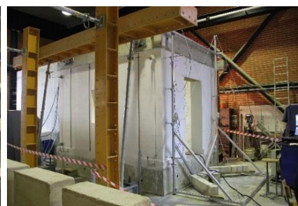
Figura 3.10 - Parede de reação utilizada no ensaio cíclico sobre a fachada Sul.
