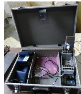
Figura 5.16 - Caixa onde se encontra instalada a placa de aquisição de dados.
