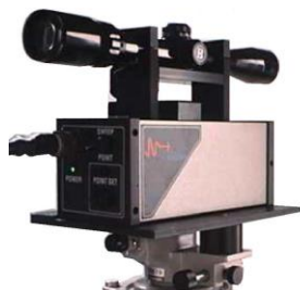
Figura 2.10 - Transdutor laser de deslocamento da marca Noptel Oy , modelo PSM- 200 (Noptel Oy, 2014a)
