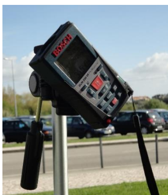
Figura 4.4 - Ilustração do laser utilizado nas medições efetuadas na estrutura.
