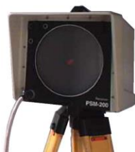
Figura 2.10 - Transdutor laser de deslocamento da marca Noptel Oy , modelo PSM- 200 (Noptel Oy, 2014a)
