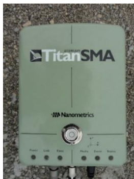
Figura 4.8 - Acelerómetro triaxial de movimento forte, modelo TitanSMA, da marca Nanometrics ®.
