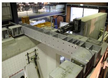
Figura 3.9 - Barra metálica e servo-atuador hidráulico utilizados no ensaio.
