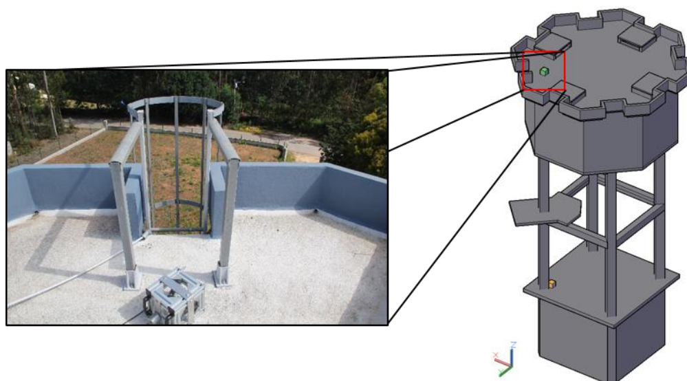
Figura 5.21 - Localização e pormenor do alinhamento do cubo móvel (cubo verde) no setup 2.
