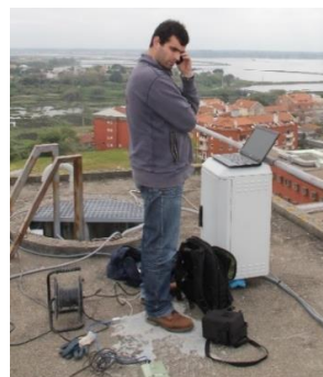
Figura 4.9 - Montagem do sistema de aquisição de dados para o ensaio dinâmico de vibração ambiental.
