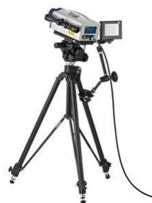
Figura 2.6 - Transdutor laser de velocidade da marca Polytec , modelo RSV-150 ( Polytec , 2014).
