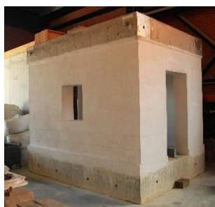
Figura 3.8 - Casa de adobe imediatamente antes do ensaio.
