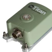
Figura 2.26 - Macro-sismógrafo da marca Nanometrics, modelo Titan (Nanometrics, 2014).
