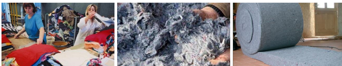
Figura 4.4– Processo construtivo do isolamento Métisse
