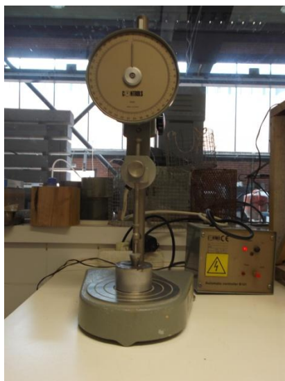
Figura 5.5- Instrumento usado para o Ensaio Cone Penetrómetro.
