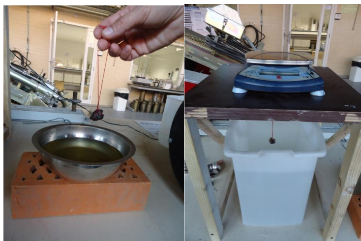
Figura 5.7- Imagens obtidas durante a determinação do peso volumétrico pelo método da parafina.
