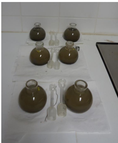
Figura 5.6- Pícnómetros usados na determinação do peso volumétrico das amostras.
