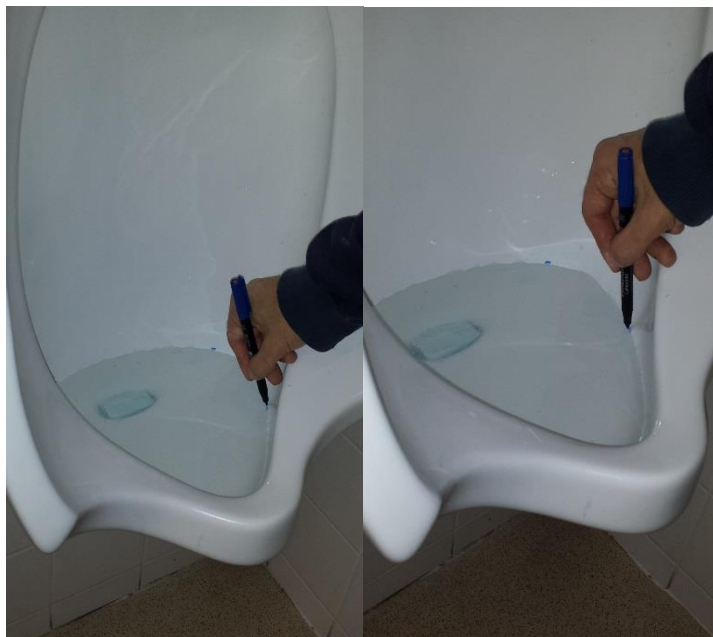
Figura 23 - Marcação do nível da água
