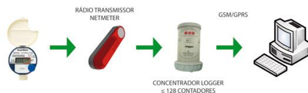
Figura 32 - Esquema exemplificativo do sistema de telecontagem (Tecnilab,2014)
