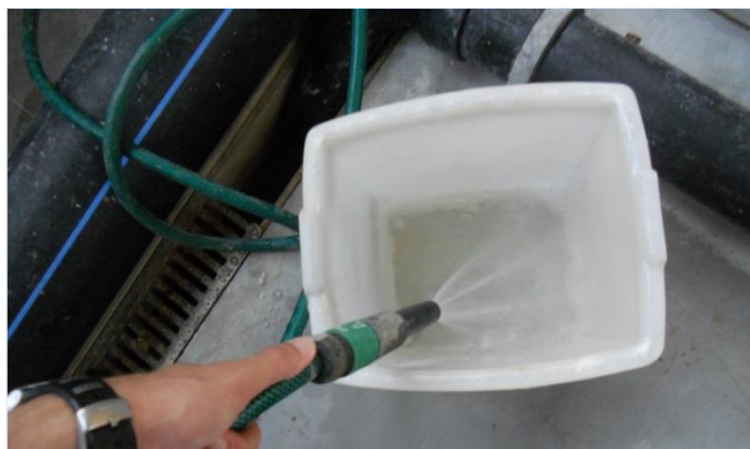
Figura 27 - Medição do caudal de água debitado pelas torneiras "verhal"/"bugatti" (laboratório)
