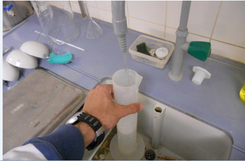
Figura 25 - Medição do caudal de água debitado pelas torneiras de laboratório
