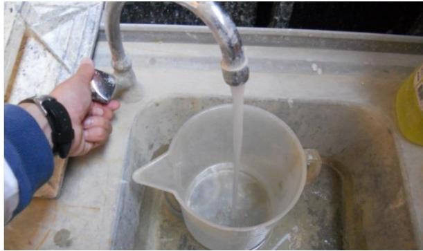
Figura 26 - Medição do caudal de água debitado pelas torneiras das pias de cozinha (laboratório)
