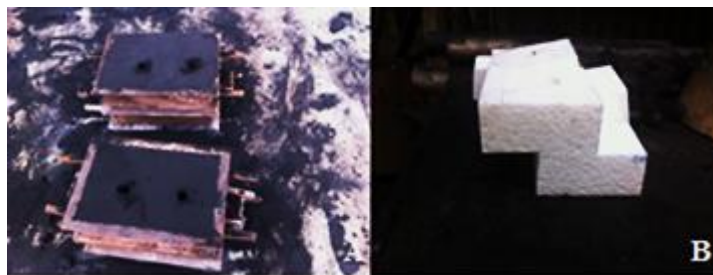
Figura 13: caixa de moldação e modelo de EPS usado.
