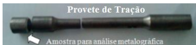
Figura 12: Provete de tação e amostras para análise metalográfica.
