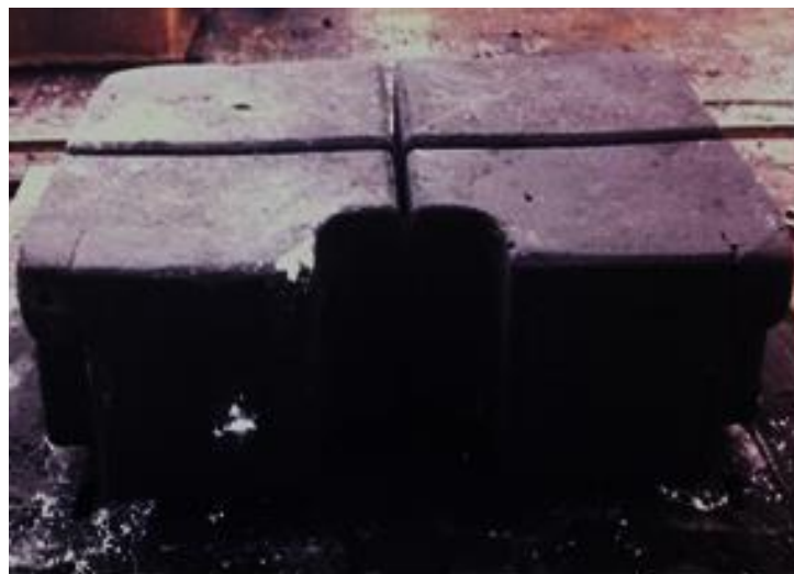
Figura 23: moldação após a degradação total do EPS.
