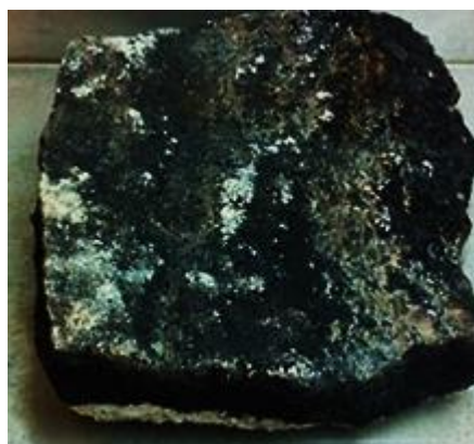
Figura 16: bloco de revestimento refratário tal como é habitualmente descartado.
