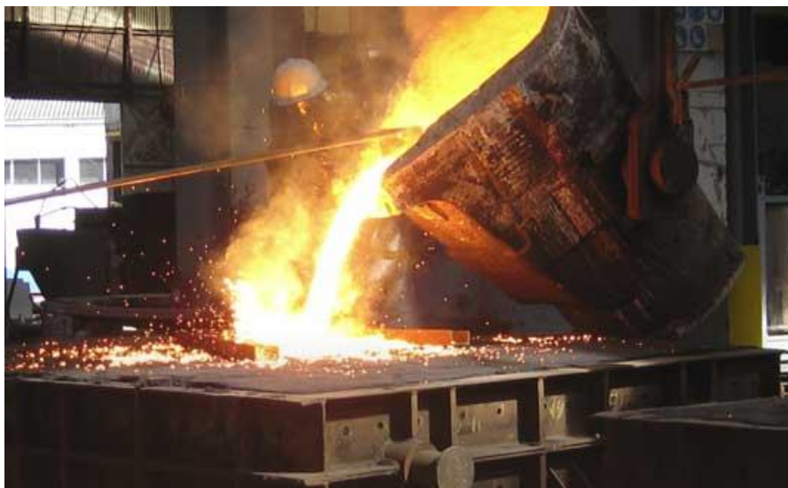
Figura 2: exemplo de um vazamento manual realizado na Duritcast 1 .
