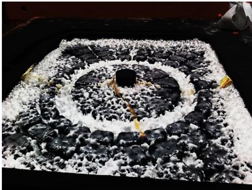
Figura 25: estado de degradação do modelo de EPS ao fim 4 horas de reação.
