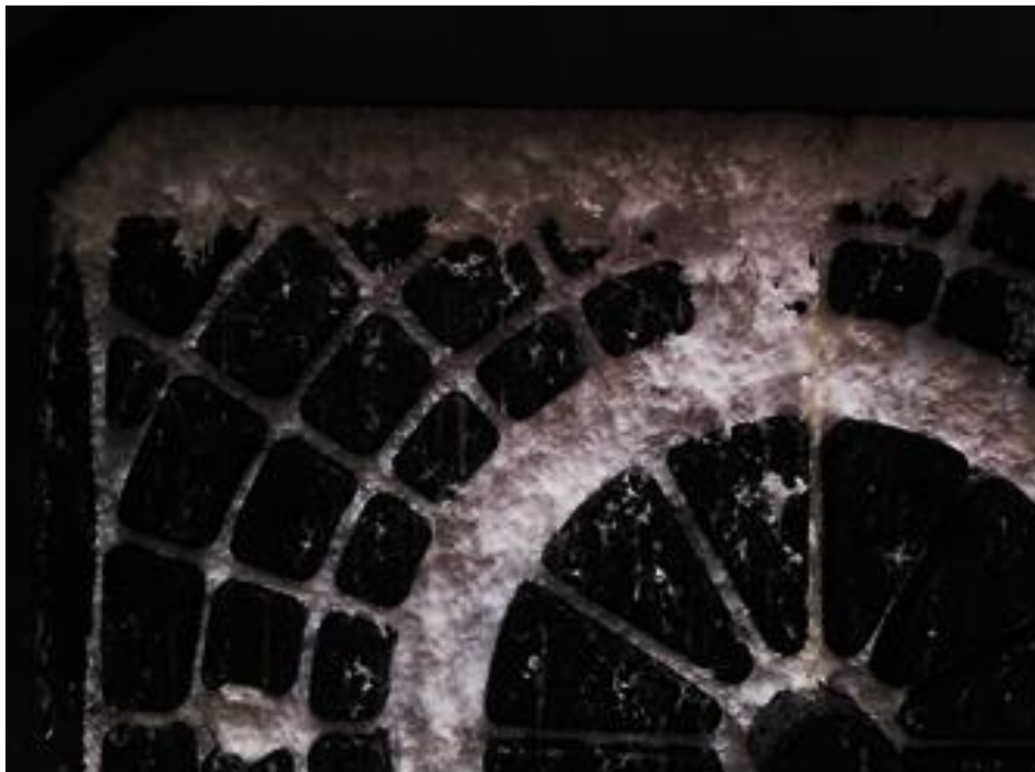
Figura 29: estado de degradação do modelo de EPS ao fim 4 horas de reação.
