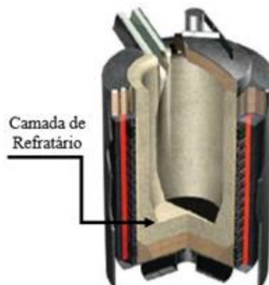
Figura 3: representação esquemática do interior de um forno de indução 6 .
