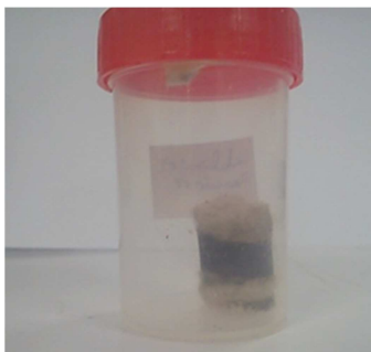
Figura 3.4: Imagem do catalisador usado contendo coque.
