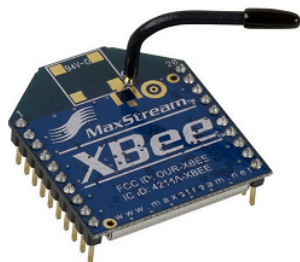
Figura 3.4: Módulo XBee XB24-Z7WIT-004 da Digi®.
