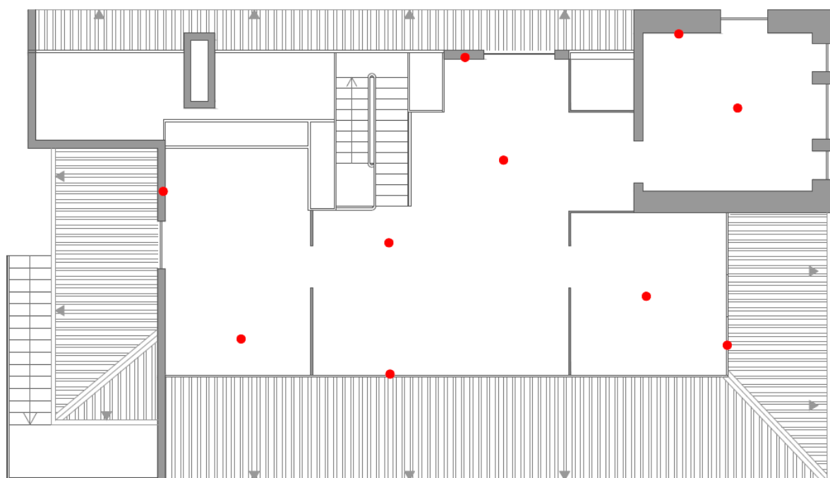
Ilustração 98 - Identificação dos pontos de ensaio com Resistógrafo. Piso 2
