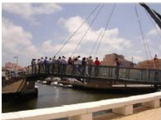
Ilustração 1 - Ensaio de carga sobre a ponte (Barbosa et al. , 2008)
