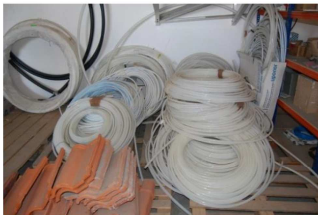
Figura 21. Tubo PEX (diâmetro 16) de pouca utilização, amontoado sem previsão de utilização.
