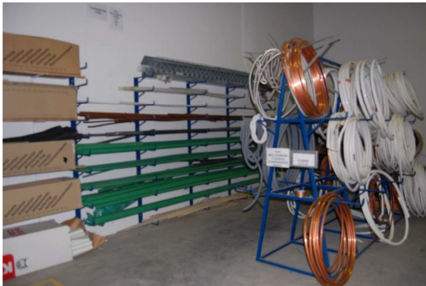
Figura 31. Estruturas metálicas adquiridas para suporte da tubagem em vara e em rolo.
