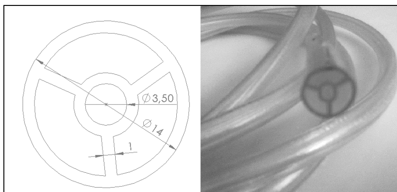
Figura 32 – À esquerda, dimensões do tubo, à direita representação do tubo PCM após extrusão.
