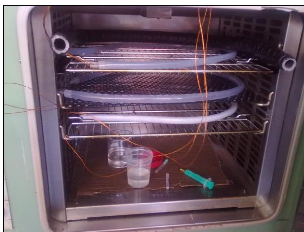
Figura 34 – O repouso das amostras antes de serem introduzidas na estação laboratorial oi feita com recurso a ma estufa.
