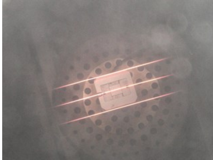
Figura 3.7: Representação do bloco de moldação com os 3 filamentos colocados horizontalmente.
