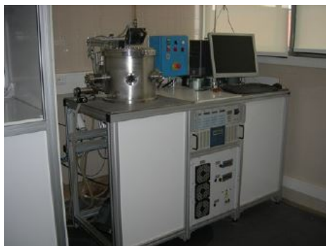
Figura 3.6: Reator HFCVD utilizado para efetuar a deposição do filme de diamante nanocristalino.
