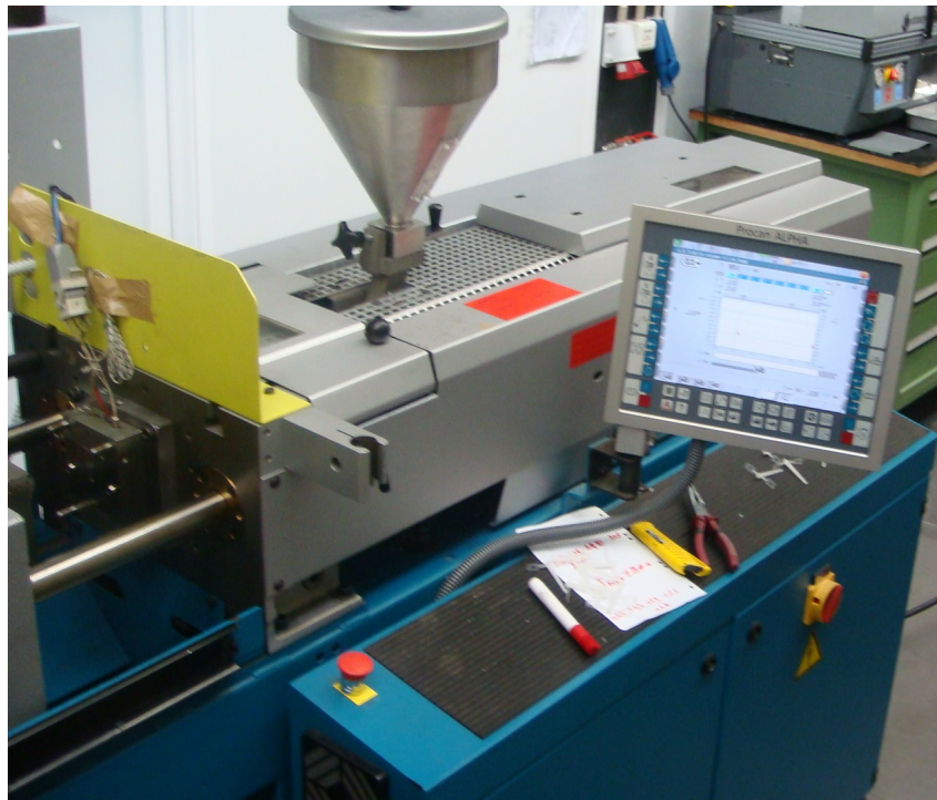
Figura 3.15: Máquina de microinjeção por moldação Dr. Boy 12 A.
