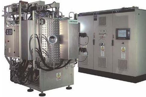
Figura 3.3: Equipamento utilizado no revestimento do CrN [62].
