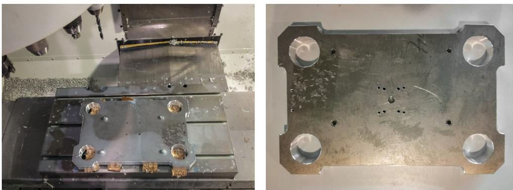
**Figura 28** – Maquinagem da plataforma no centro de maquinagem CNC (esquerda); plataforma em alumínio já concluída (direita).
