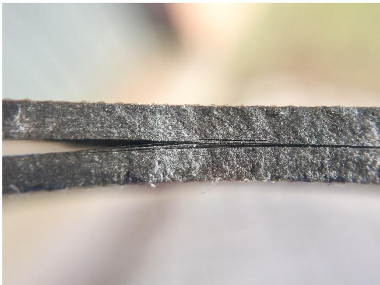
**Figura 75** – Fotografia tirada através de uma lupa a um provete com dupla fenda.
