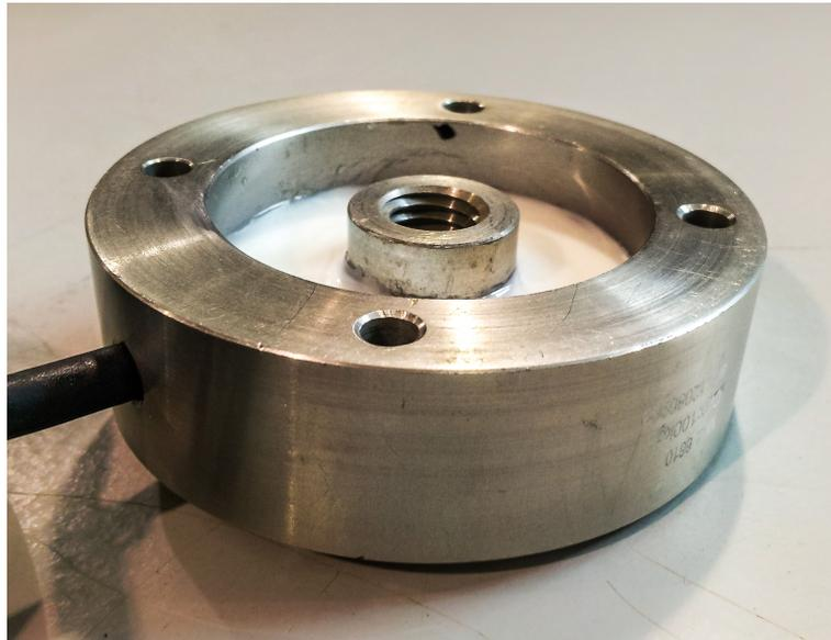
**Figura 42** – Célula de carga tipo “disco”.
