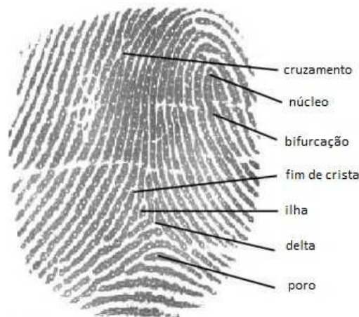
Figura 2.5: Representação de um template comum, obtido por tecnologia de reconhecimento por impressão digital, com descrição dos pontos característicos da análise [22]
