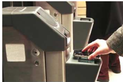
(b) Equipamento de bilheteira eletrónica onde o utilizador aproxima o dispositivo para validar a entrada, ou comprar o bilhete
