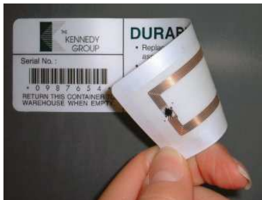
Figura 2.12: Exemplo de uma tag passiva [40]
