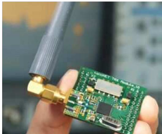
Figura 2.13: Exemplo de uma tag ativa [39]
