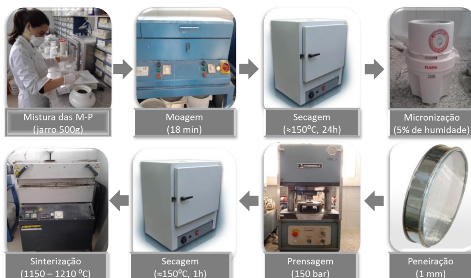
Figura 9 - Procedimentos utilizados para a preparação de pastas.
