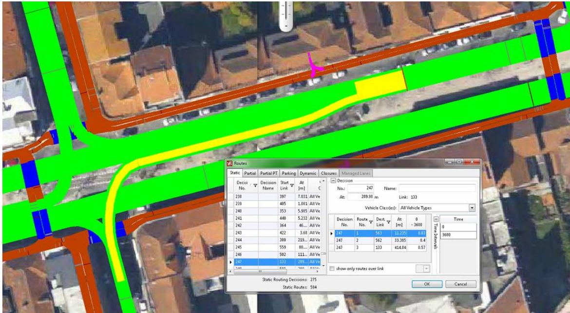
Figura 23: Definição de rotas no modelo
