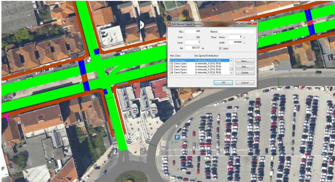
Figura 19: Representação da definição de velocidades no VISSIM
