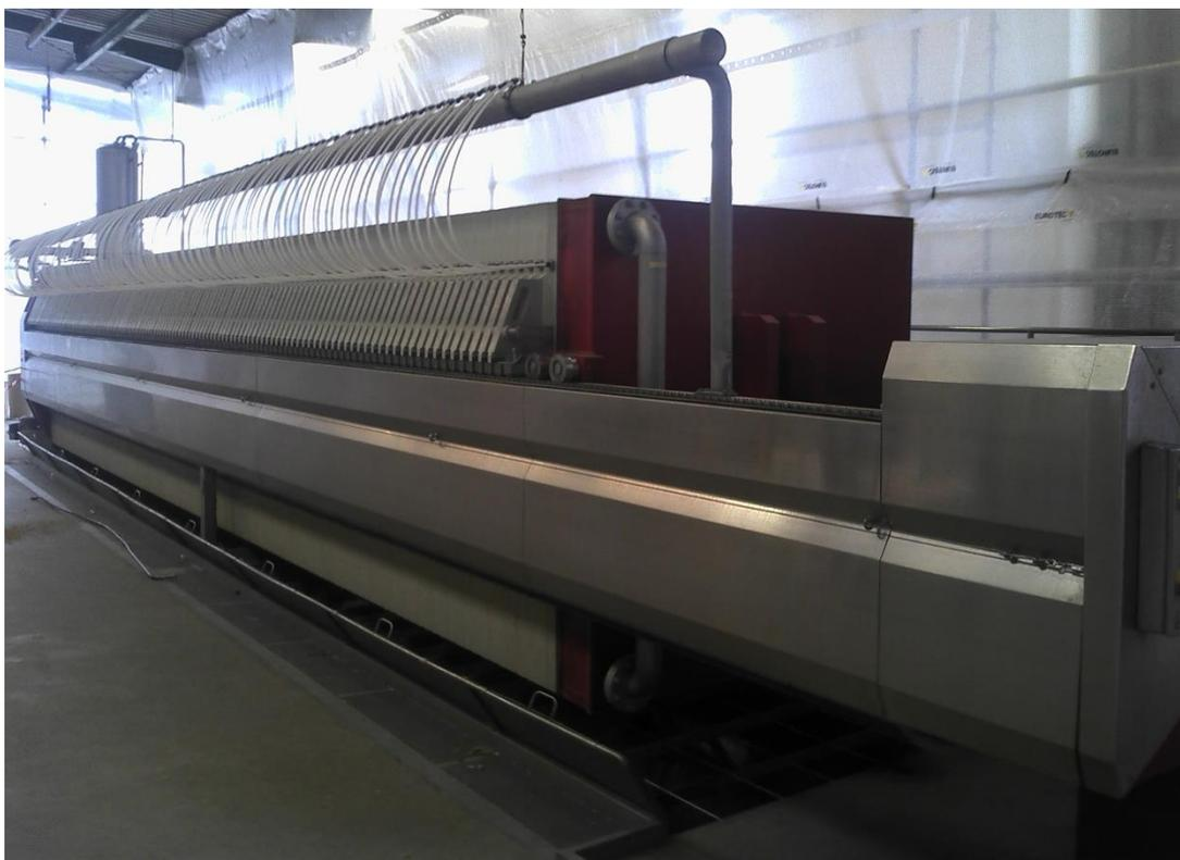
**Ilustração 6 – Filtro horizontal de placas verticais utilizado na produção de mosto na UNICER.**
