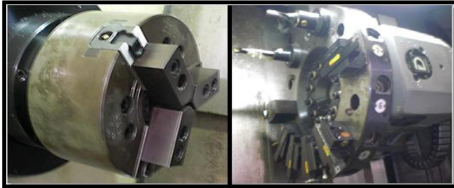
Figura 3.5 - Bucha e Torreta do torno CNC Kingsbury MHP 50 (cortesia do DEM-UA).
