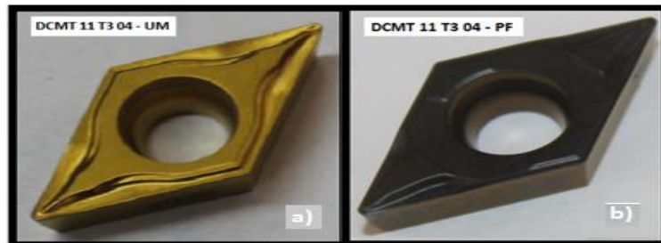
Figura 3.3 - Pastilhas de corte utilizadas nos ensaios experimentais a) DCMT 11 T03 04-UM (revestida), b) DCMT 11 T03 04 - PF (sem revestimento).
