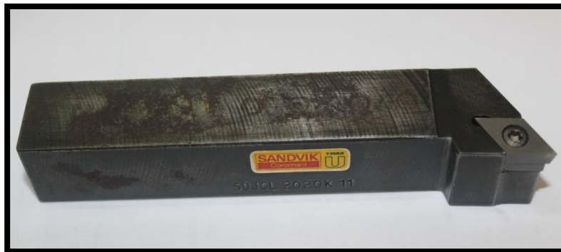
Figura 3.2 – Porta- ferramenta utilizado nos ensaios (Sandvik, 2002).
