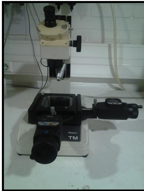
Figura 3.11 - Microscópio de oficina Mitutoyo TM (cortesia DEM-UA).
