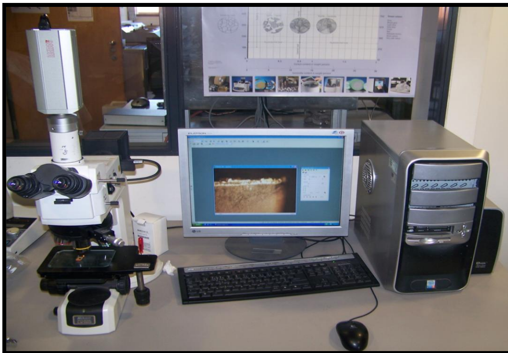
Figura 3.12 - Microscópio óptico Nikon Eclipse LV150 (cortesia DEM- UA).
