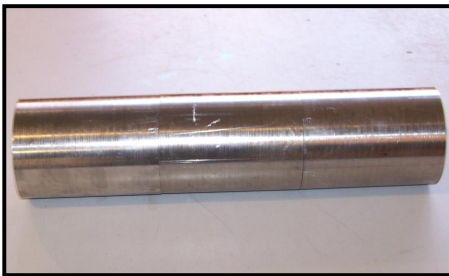
Figura 3.1 - Aspeto do provete do aço inoxidável AISI 316 utilizado nos ensaios.
