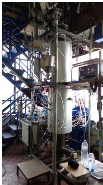
Figura 4.1. Instalação experimental de combustão em leito fluidizado à escala piloto.
