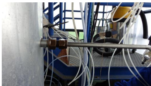
Figura 4.8. Sonda de amostragem de gases do reator de leito fluidizado á escala piloto.
