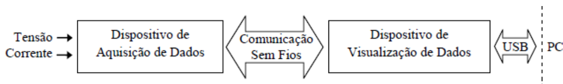
Figura 11 - Diagrama de blocos geral do sistema de monitorização. [João Gil Josué, 2010]
