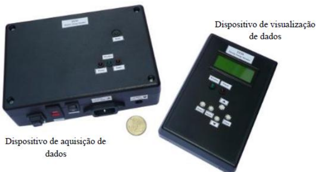
Figura 10 - Sistema desenvolvido, composto pelo dispositivo de aquisição de dados e pelo dispositivo de visualização de dados. [João Gil Josué, 2010]
