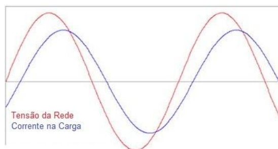
Figura 20 - Comportamento da corrente com carga indutiva.
