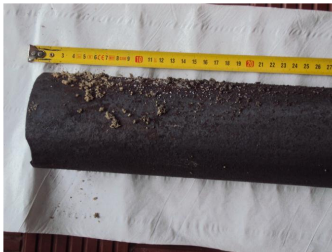
Figura 18 – Tubo de descarga da biomassa após experiências de combustão em leito fluidizado na instalação à escala piloto
