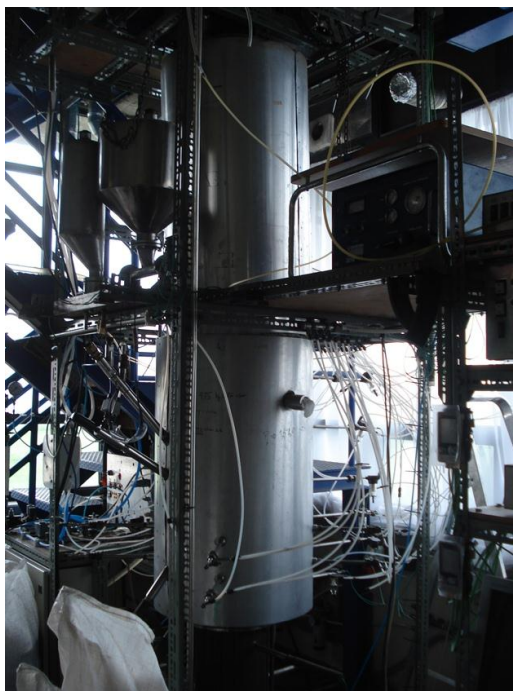
Figura 2 - Instalação experimental de combustão em leito fluidizado à escala piloto
