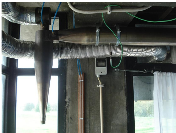
Figura 8 – Sistema de despoejamento do reator de leito fluidizado à escala piloto
