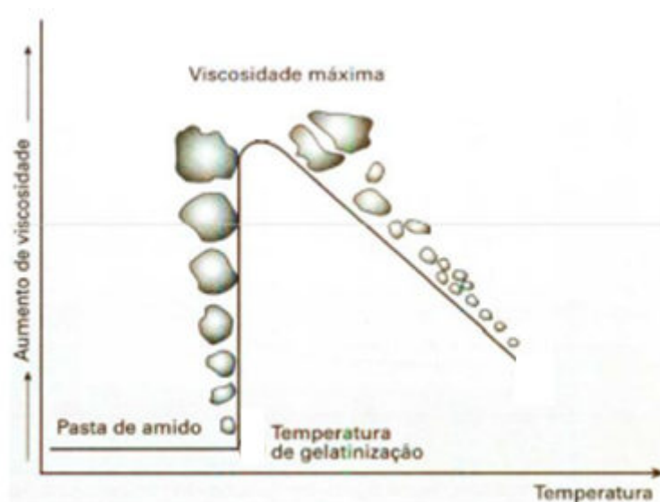
Figura 11 - Efeito da temperatura na viscosidade de uma solução aquosa de amido nativo.[18]
