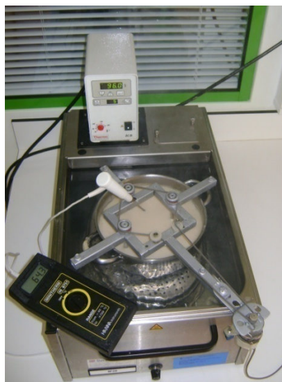
Figura 22 - Dispositivo mecânico para agitação homogênea de 3 réplicas, adaptado para a pré-gelatinização de amidos de farinhas, para incorporação em preparados de fruta.
