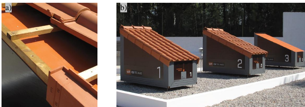
Figura 172 - 3: a) Célula 2 com cobertura ventilada; b) Vista geral das células durante a experiência [37]
